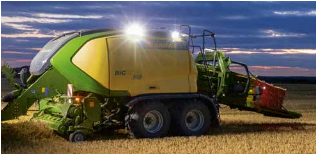
Arbeitsbeleuchtung auf den Garnkästen
