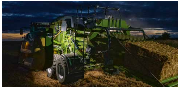
Beleuchtung hinter den Garnkästen
