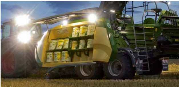
Beleuchtung in den Garnkästen
