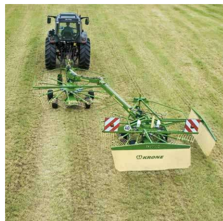
Dépose d'un seul andain à droite
