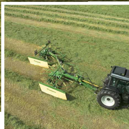
Dépose de deux andains Deux andains sur 6,80 m
