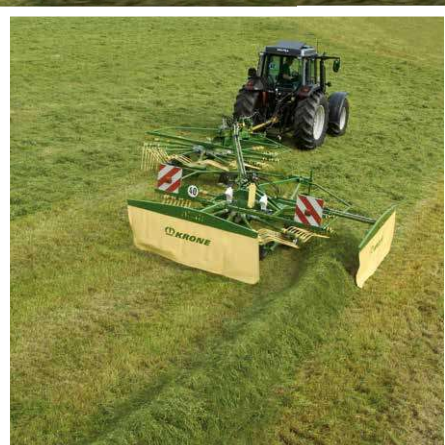
Dépose d'un seul andain Un andain sur 6,20 m
