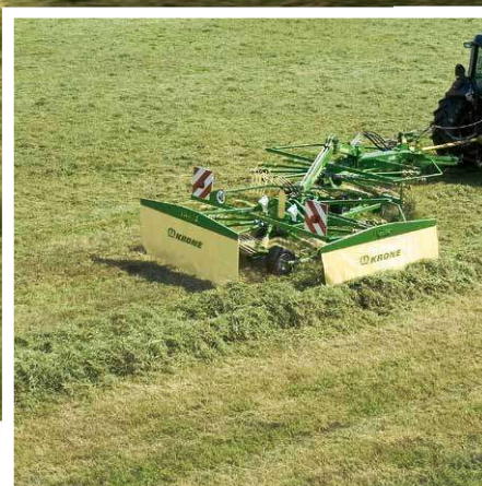
Dépose d'un andain double Un andain double sur 12,40 m
