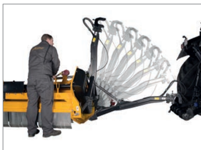
Schnell einsatzbereit: Maschine abhängen und Langfahreinrichtung in Arbeitsposition bringen / MU-Farmer® 670 mit der Schnellkuppelstange am Traktor einhängen und Gelenkwelle anschließen.
