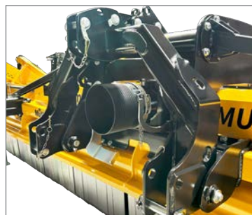
Anbau an Quick-Hitch-Aufnahme möglich.
