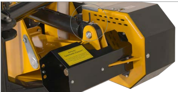
Gut zu erreichende Transportsicherung.
