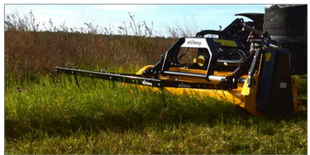
Insektenretter: durch einen speziell konzipierten, hydraulisch klappbaren Bügel mit integrierten abgewinkelten Zinken werden Insekten und Kleinstlebewesen vor dem Mulchgerät aufgescheucht und zur Flucht bewegt. (optional für Arbeitsbreiten von 1,60 m und 2,20 m)
