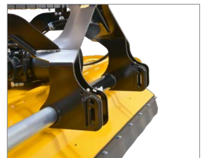
Langlöcher in Kat. 2 an den Ober- und Unterenkerbaupunkten ermöglichen zusammen mit der Schwenk-Stützwalze eine sehr gute Boden Anpassung.
