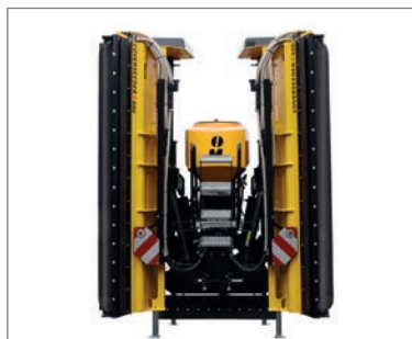
Klappung auf unter 3 m Transportbreite.
