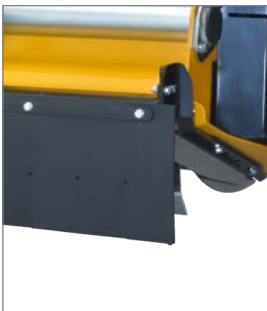
Erweiterte Abhalteeinrichtung bei extrem starkem Steinbesatz (optional).
