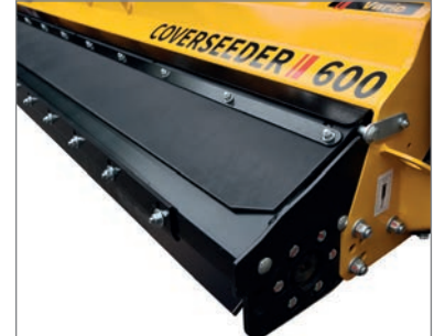
Große Stützwalze mit robuster Starintha Stützwalzenlagerung zur Arbeitshöhenverstellung des Mulchgerätes und zur Erzeugung des Bodenschlusses für das Saatkorn.
