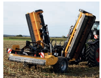
Schnelles Ein- und Ausklappen bei einer Transportbreite unter 3 m.
