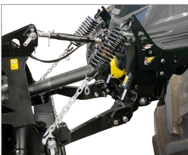
Die Frontfederentlastung sorgt für eine optimierte Boden Anpassung und führt durch eine Belastung der Vorderachse zur besseren Traction und Lenkeigenschaft des Traktors (optional).
