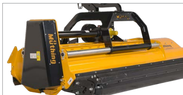
Mit zwei stabil ausgeführten Adapterplatten lässt sich die Gutablage auch vor der Stützwalze realisieren (optional).
