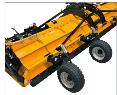
4 bodenschonende Stützräder zur Höheneinstellung am MU-Farmer® für den Heckanbau. 180° schwenkbar für hohe Wendigkeit am Vorgewende.
