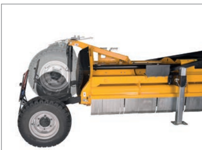
Schnell einsatzbereit: Maschine abhängen und Langfahreinrichtung in Arbeitsposition bringen / MU-Farmer® 670 mit der Schnellkuppelstange am Traktor einhängen und Gelenkwelle anschließen.
