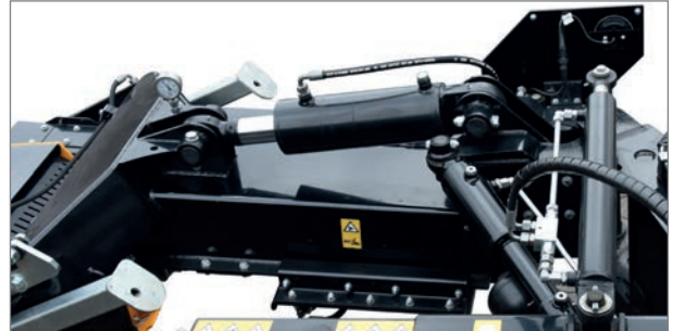
Hydropneumatische Auflagedruckentlastung für optimale Boden-anpassung.
