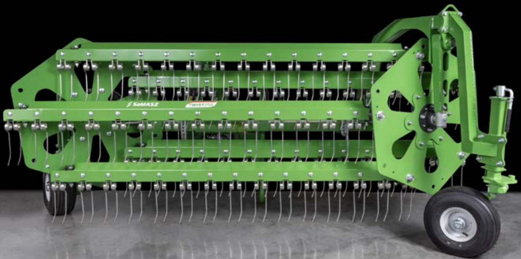
La conception compacte de l'andaineur frontal TWIST, conçu pour travailler près du tracteur, assure une grande efficacité sur les terrains irréguliers et montagneux. Le système innovant à peignes garantit une propreté optimale du fourrage et la protection du sol.
