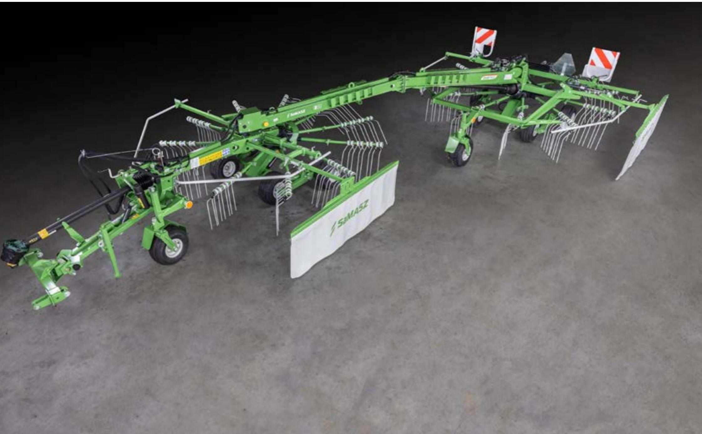
Une machine conçue pour les grandes exploitations agricoles et les prestataires de services. La polyvalence de la série TANGO se manifeste par sa capacité à former 1 ou 2 andains sans avoir à ajuster le système de travail arrière. Cela permet d'adapter la machine de manière flexible aux besoins et aux conditions de travail actuels.
