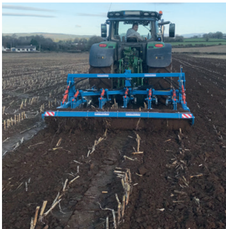
V Form 5 Zinken Ackerbau Panbuster Konventioneller Zinken & Scheibe
