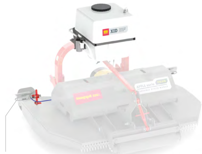
APPLE vario: Einstellbare Düsenhalterung mit Anfahrsicherung - transparenter Düsenschutz
