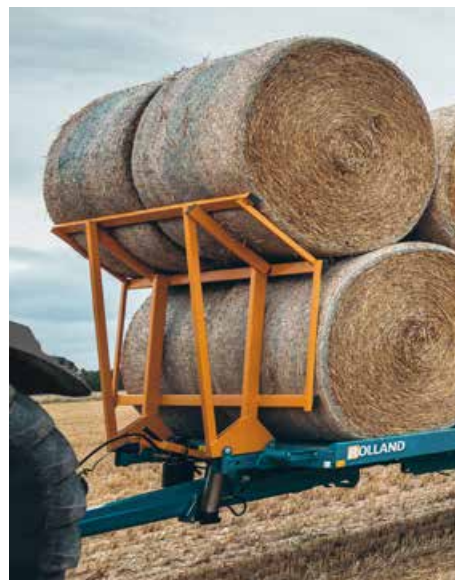
3 Hauteur 1,70 m coudée, idéale pour les balles rondes
