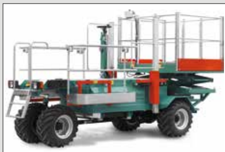
A special platform for the installation and maintenance of nets Hebebühne für Arbeiten an den Netzen
