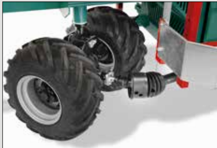
Double front wheel and 4 WD Zwillingsrad vorne mit Allradantrieb
