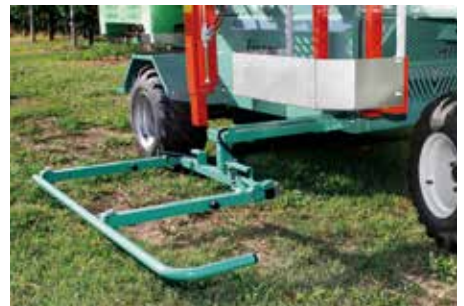
Automatic steering system with retractable sidebar Automatische Lenkung mit Seitentaster
