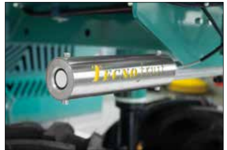
Automatic steering system with ultrasound system Automatische Lenkung mit Ultraschallsensoren
