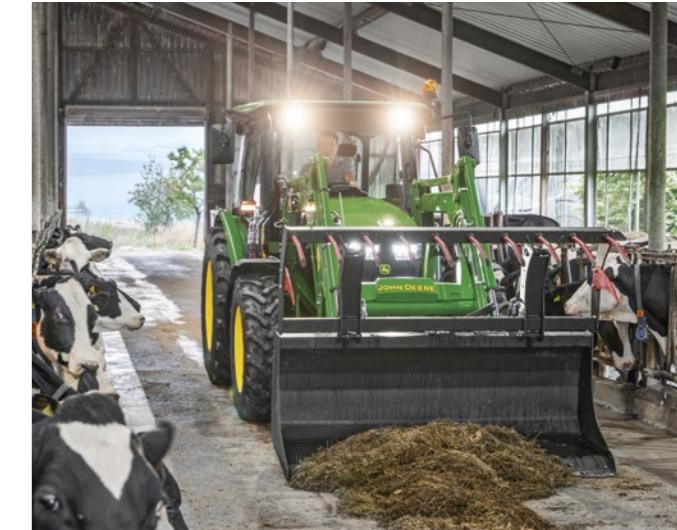
Fahren Sie bei Bedarf besonders langsam und konstant. Der Kriechgangsatzt erlaubt eine extrem niedrige Arbeitsgeschwindigkeit von nur 280 m/h.
