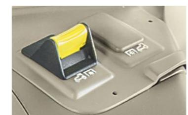
Mit der elektrohydraulischen Zapfwellenbetätigung schalten Sie bequem per Schalter die Zapfwellen zu und ab.
