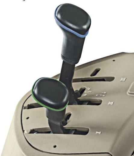
Zur bequemen Bedienung der bis zu zwei Zusatzsteuergeräte sind an der rechten Bedienkonsole zwei praktische Bedienhebel vorgesehen.
