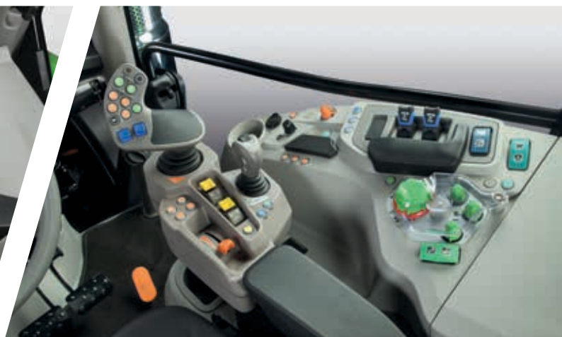
> Configuration du distributeur entièrement électronique associée à la transmission TTV.
