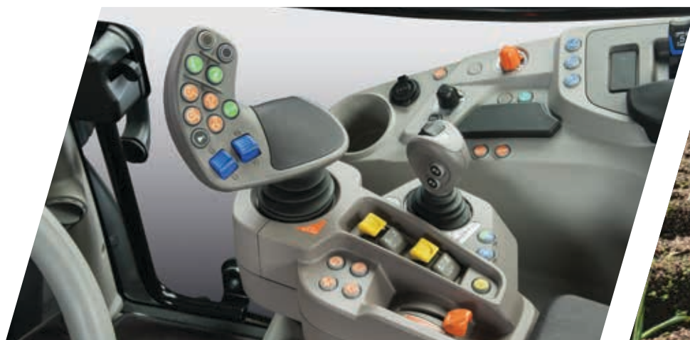
> Accoudoir ergonomique avec joystick MaxCom
