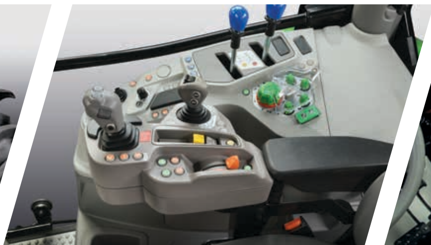
> Configuration hydraulique mixte avec 2 distributeurs mécaniques et 2 distributeurs électroniques adaptées à la transmission RVshift.
