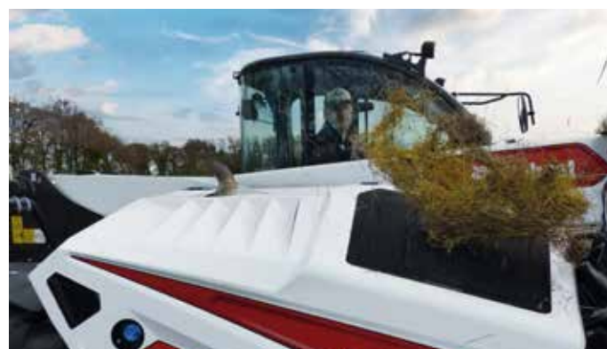
Gebälde mit Richtungsumkehr, manuell oder automatisch
