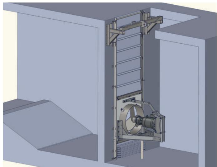
Das Rührwerk kann in Gruben bis zu einer Tiefe von 4 m eingebaut werden. Mit Hilfe einer Seilwinde lässt es sich in der Höhe verstetlen. Die Seilwinde ist verzinkt und mit einem Edelstahl-Drahtseil bestückt.
