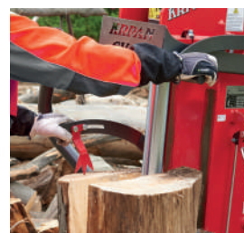
Linke Bedienungshebel mit integrierter Spaltgutfixierung
