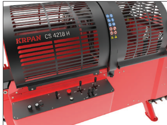
KR PAN CS 4218 H mit manuellen hydraulischen Steuerhebeln
