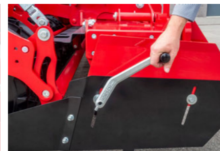
Verstellung der Seitenschilder mit dem Universalschlüssel
