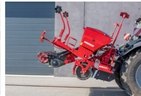
Höhere Bodenfreiheit beim Straßen-transport durch Einziehen des Hydraulikzylinders
