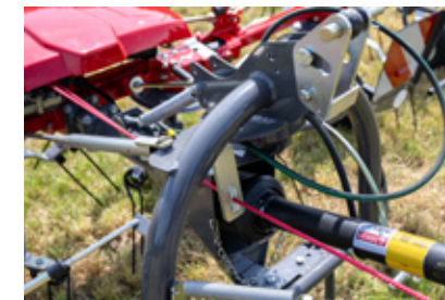
▲ Automatische Werkzeugverriegelung am Dreipunkt-Anbaubock
