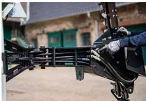
Schlauchverlegung geschützt in Rahmen
