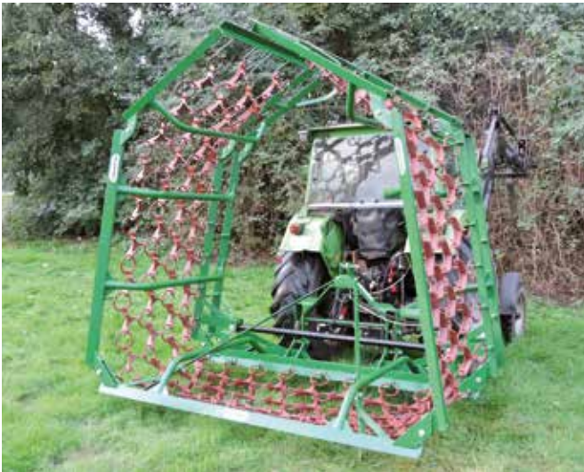
Grünlandegge 8,00 m, 4-reihig, hydraulisch klappbar
