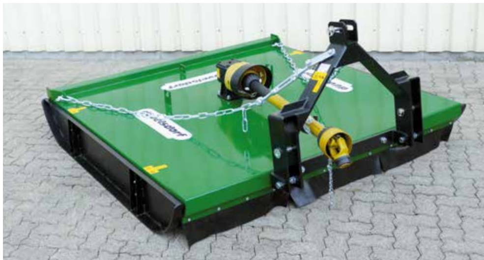
Sichelmulcher mit Gelenkwelle und Spannketten
