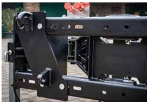
D-LOCK System für Aufnahmen verschiedenster Trägerfahrzeuge
