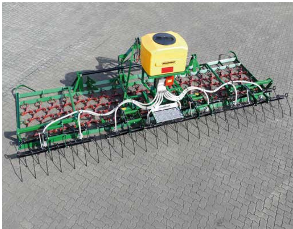
Grünlandegge 6 m mit Striegelfeld und Sägerät
