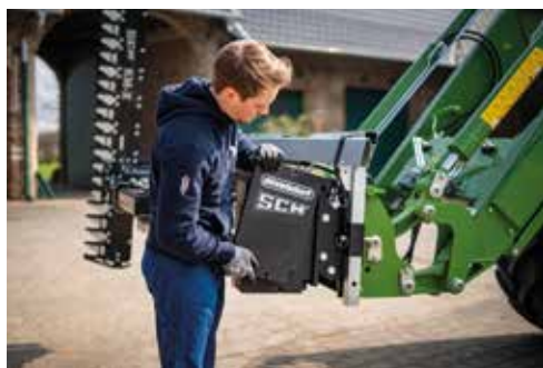
Ausgleichsgewichte können einzeln nach Bedarf dazugehängt werden
