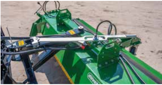
Beidseitige mechanische Schrägstellung
