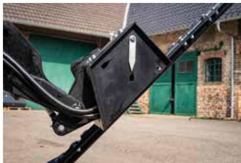
Integrierte Winkelanzeige für maximale Präzision
