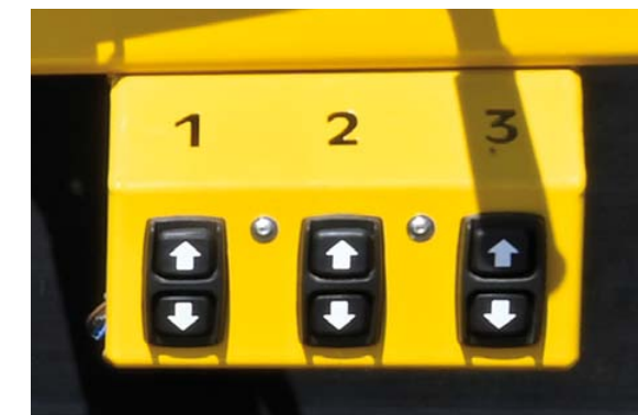
Höhenverstellung der Ableitwalzen mittels Linak Linearantriebe
