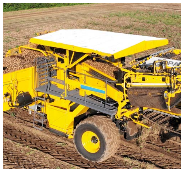
Sonnenschutzdach, höhenverstellbar (optional, erweiterbar um Seitenverkleidung)
