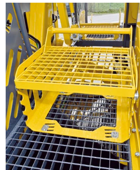
Höhenverstellbare Podeste, frei positionierbar
