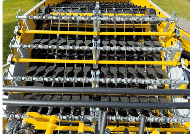
Verbesserter Krautkettenverlauf und Krautrückhaltefedern
