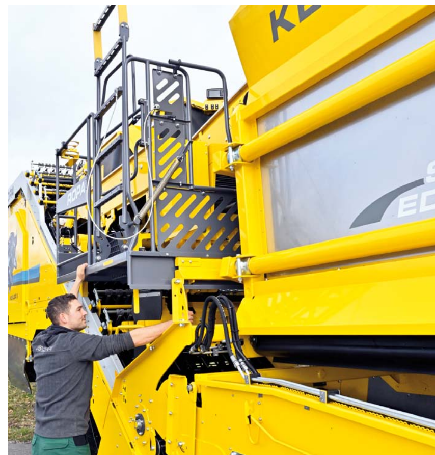
Arbeitspodest, 300 mm ausziehbar - großzügige Arbeitsfläche für mehr Bewegungsfreiheit
