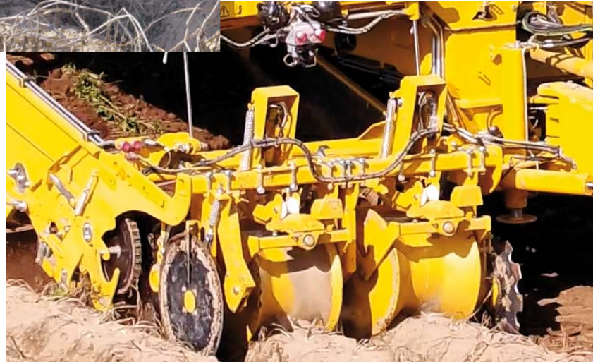
Gezackte Hohlzscheibe innen, zusätzliches Scheibensech aussen
