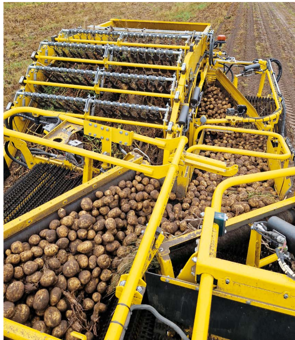
Keiler 2 4-Igel ohne umlaufenden Fingerkamm
