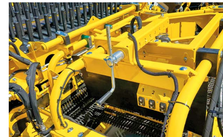
Horizontale Verschiebung der Ableitwalzen am Igel 3
