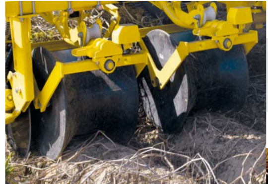
Dammtrommeln aus Kunststoff, hydraulisch angetriebenes Scheibensech aussen
