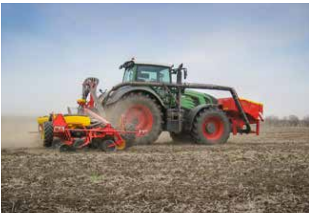
Der vorn angebaute Fronttank FH 2200 ermöglicht eine schlagkräftige Kombiaussaat.
