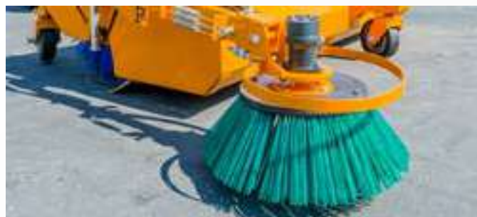
Optionaler Seitenkehrbesen mit hydraulischem Antrieb für das Reinigen an beispielsweise Straßenrändern
