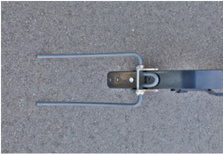
La herse de recouvrement équipant chaque élément semeur TurboDisc est guidée individuellement pour une meilleure efficacité dans le travail du sol
