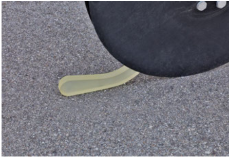
L’uniformer HORSCH en téflon garantit une dépose précise de la semence
