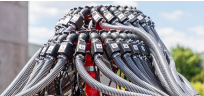
Contrôle du flux d'engrais et de semence – pour un contrôle en continu du système de distribution en engrais et semence
