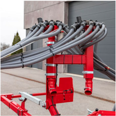
Possibilité de n’alimenter qu’une seule des deux têtes de distribution pour semer un rang sur deux
