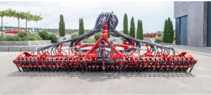
Réglage hydraulique de l'agressivité en continu
