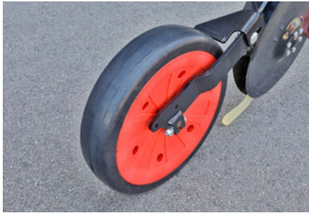
Roulette de rappe 7 cm de large – idéale pour les sols légers
