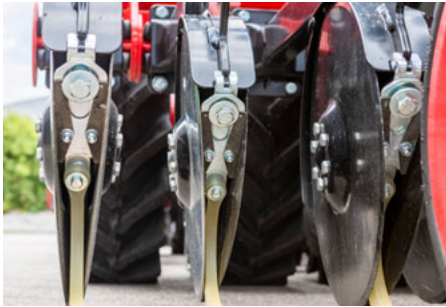
Le décrotteur mobile garantit un auto-nettoyage en conditions humides.
