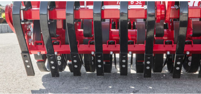
Crossbar à réglage hydraulique pour un nivellement supplémentaire devant le packer
