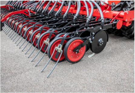
Elément semeur HORSCH TurboDisc
