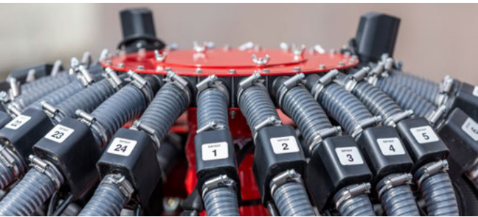
Contrôle du flux pneumatique sur la tête de répartition
