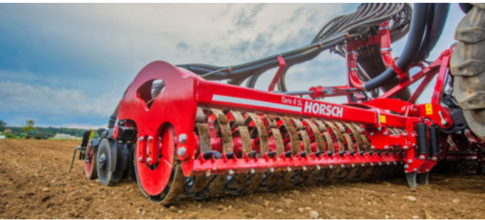
Rouleau RollFlex : rappui en profondeur, émiettement optimal des mottes
