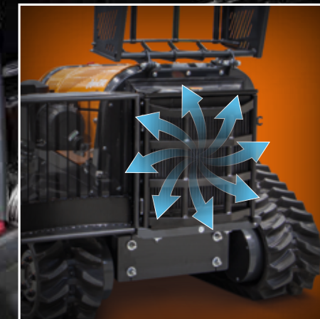
VENTILATEUR HYDRAULIQUE RÉVERSIBLE AUTO-NETTOYANTE FREXXAIRE®
