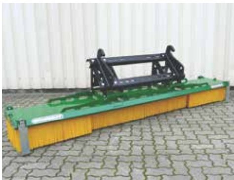
D-LOCK Aufnahme (mit montierter Schaffer Aufnahme)
