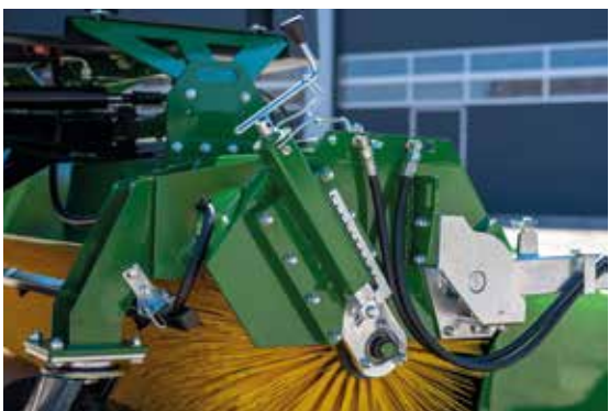
Schnelle Höheneinstellung der Bürsten
