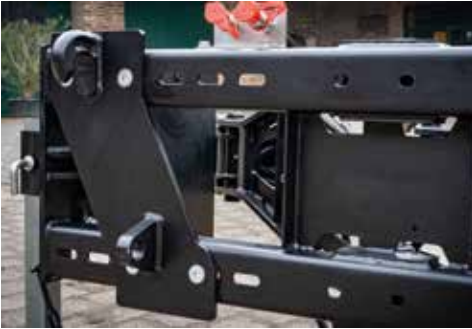
D-LOCK System für Aufnahmen verschiedenster Trägerfahrzeuge
