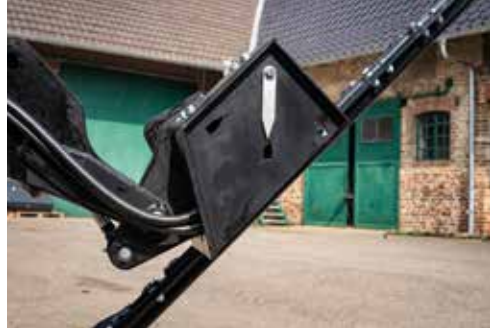
Integrierte Winkelanzeige für maximale Präzision
