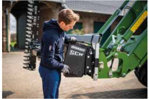
Ausgleichsgewichte können einzeln nach Bedarf dazugehängt werden
