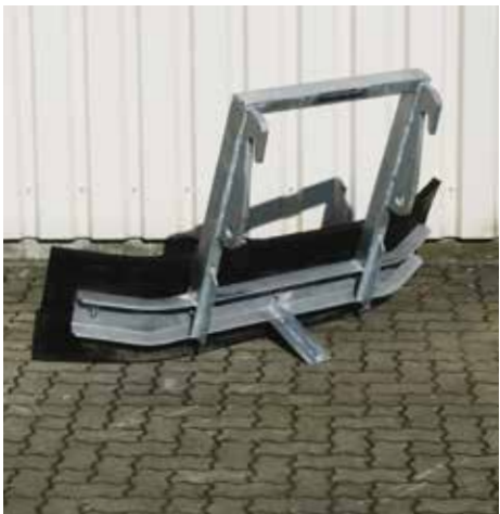
Gummischieber Weidemann 36 mm (660 mm)
