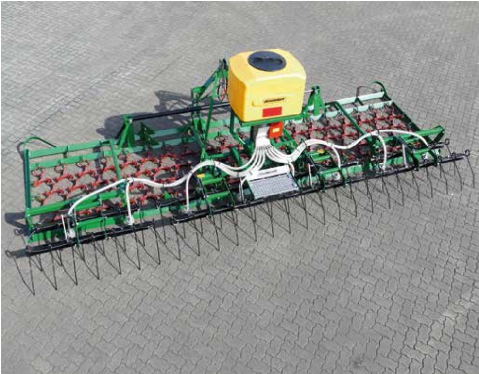
Grünlandegge 6 m mit Striegelfeld und Sägerät
