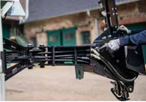
Schlauchverlegung geschützt in Rahmen
