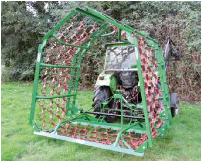
Grünlandegge 8,00 m, 4-reihig, hydraulisch klappbar
