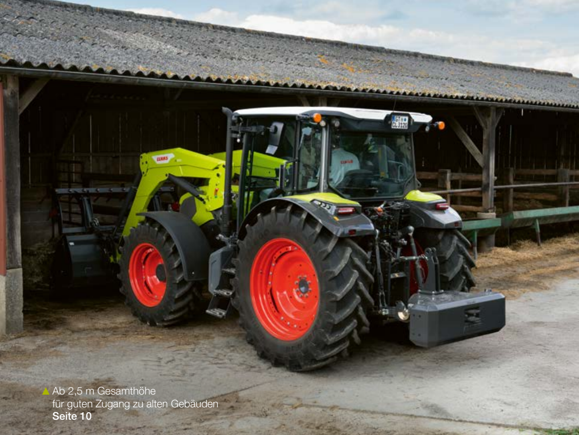
▼ 5,3 t max. Hubkraft im Heck für schwere Arbeitsgeräte Seite 12
