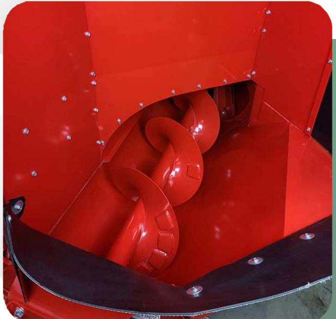
Die Leistungsfähigkeit des Rotors spielt keine Rolle, wenn die Futterzufuhr nicht funktioniert. Das Dion Gebläse hat einen übergrossen Trichter damit es weder zu Brückenbildung noch zu Verstopfungen kommt. Die Zuführschnecke ist mit 35cm Durchmesser grosszügig dimensioniert.
