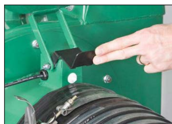
Tuyau d'aspiration pour contrôle visuel
