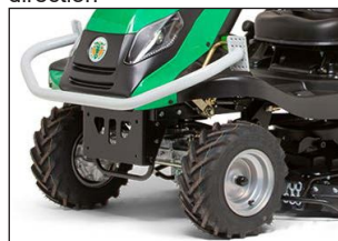
Protection frontale avec pieds supports pour terrains en pente
