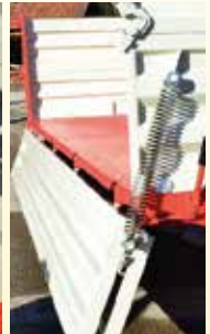
Abklappereinrichtung mit Bordwandhebefedern
