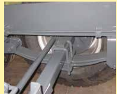
Tandemaggregat mit Paraele- ftern und tiefer gelegtem Fahr- werk, Achsen obenliegend
