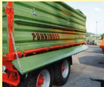
mechanische Kartoffel- und Rübenrutsche auf Wunsch seitlich oder hinten
