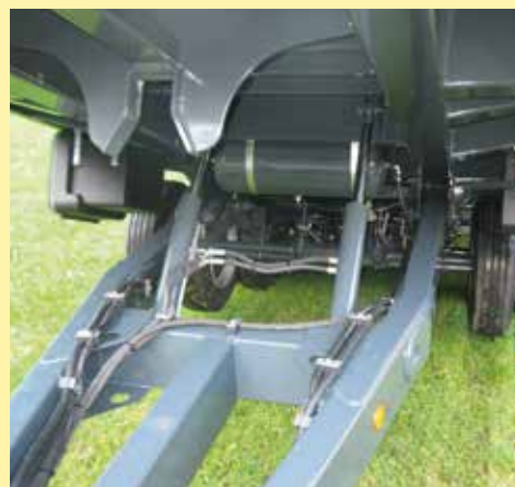
Brücke hydr. nach hinten schwenkbar
