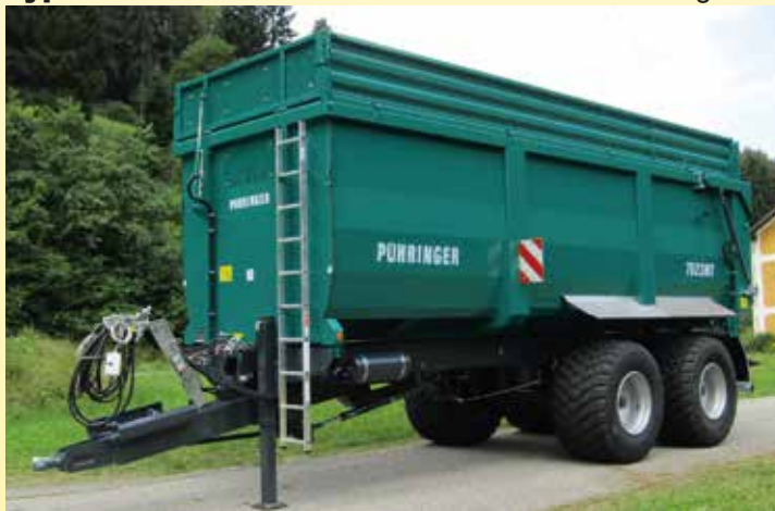
Type 7523 mit Zentraldeichsel und Deichselfederung
