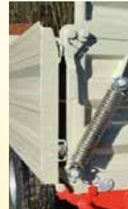
Abklappereinrichtung mit Bordwandhebefedern
