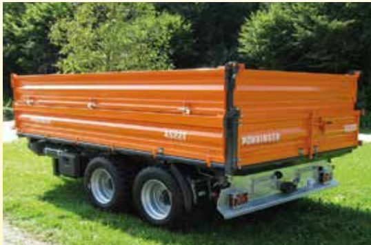
Type 4524 KT mit hydr. Heckklappe
