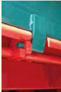
abgerundetes Brückenprofil mit stabilen Verriegelungshaken
