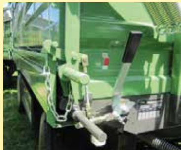
Zentralverriegelung mit selbstentriegelnder Rübenrutsche
