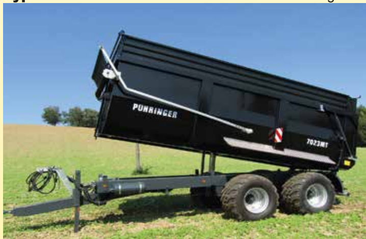
Type 7023 mit Zentraldeichsel und Deichselfederung
