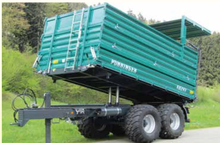
Type 5024 T mit Silieraufbau und Rollplane
