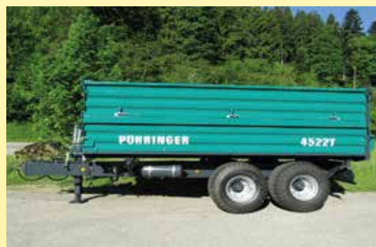
Type 4522 T hydr. Heckkl. u. erhöh. Drehlager
