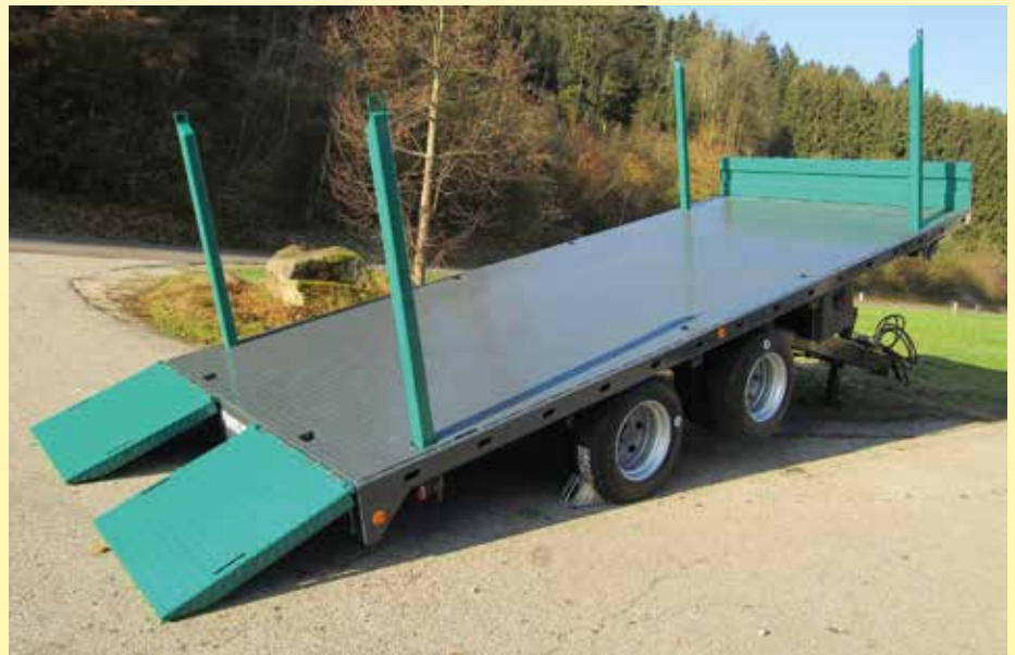
Brücke hydr. nach hinten schwenkbar
