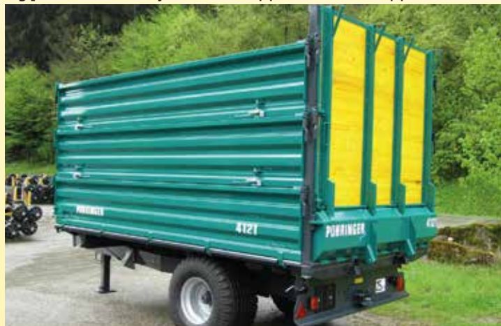
Type 4121 mit hydr. Heckklappe und Viehtreppe
