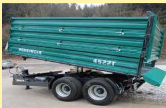
Type 4522 T hydr. Heckkl. u. erhöh. Drehlager
