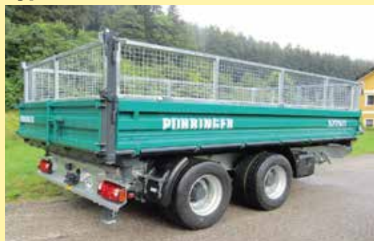
Type 5024 KT mit verz. Gitteraufbau
