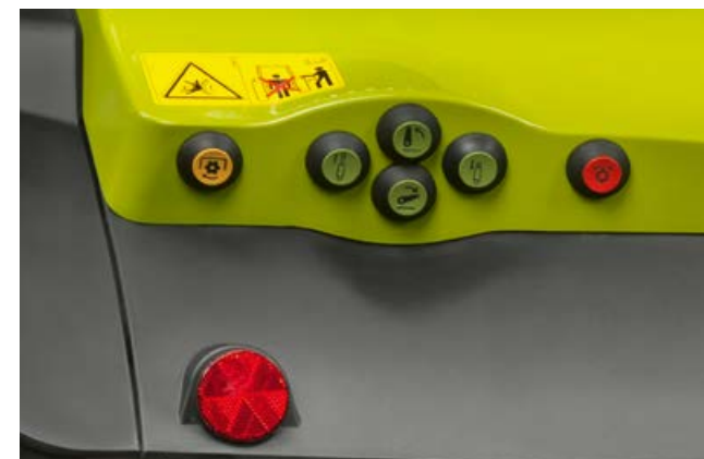
Externe Bedienung für Heckzapfwelle
