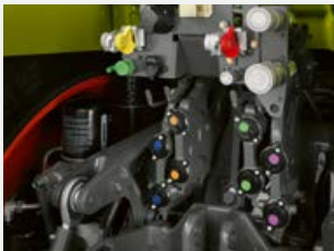
Druckluftbremsanlage mit Lufttrockner
