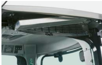
Leichter Zugang zum Kabinenluftfilter am Kabinendach
