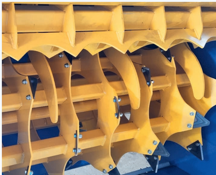
↑ Die Fräswalze mit bestückten Messern sorgt für ein perfektes Auflöseergebnis.
