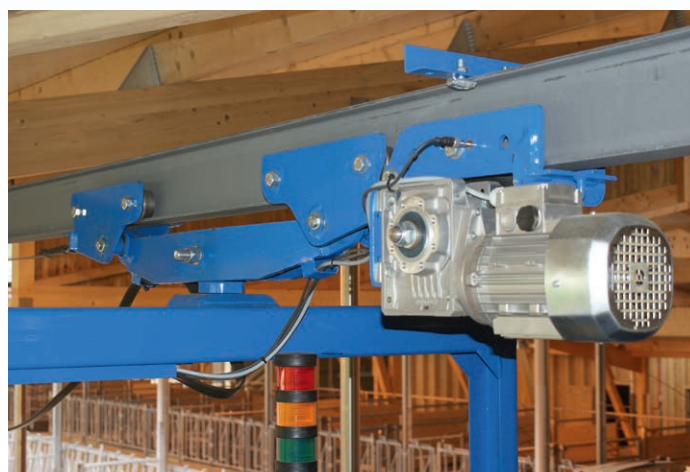
↑ Mit dem Spezialfahrwerk sind Kurven und Steigungen kein Problem.
