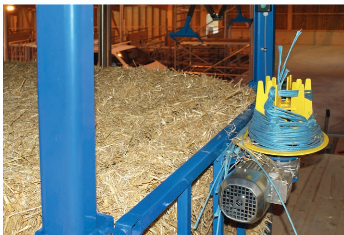
↑ Mit dem optionalen Schnurwickler werden Schnüre schnell und mühelos entfernt.
