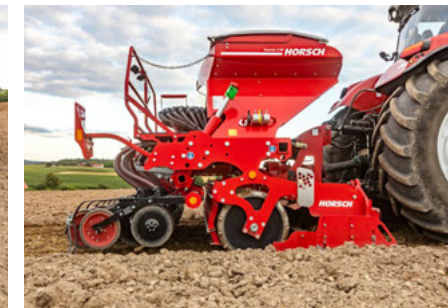
Beim Vorkreiseln am Vorgewende kann die Säschiene hydraulisch ausgehoben werden.
