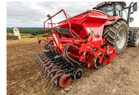
Hydraulische Sätiefenverstellung mit Clips
