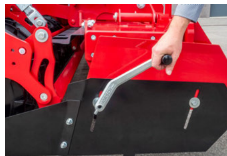
Verstellung der Seitenschilder mit dem Universalschlüssel
