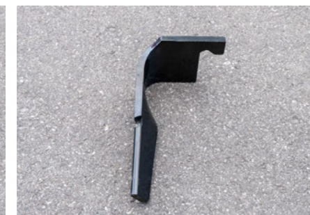
HM+ Zinken mit 130 mm Hartmetallbestückung im Schneidbereich bieten lange Standzeiten auf schweren Standorten mit Steinen
