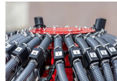
Dinkel-Pneumatik für spelzhaltige Saatgüter
