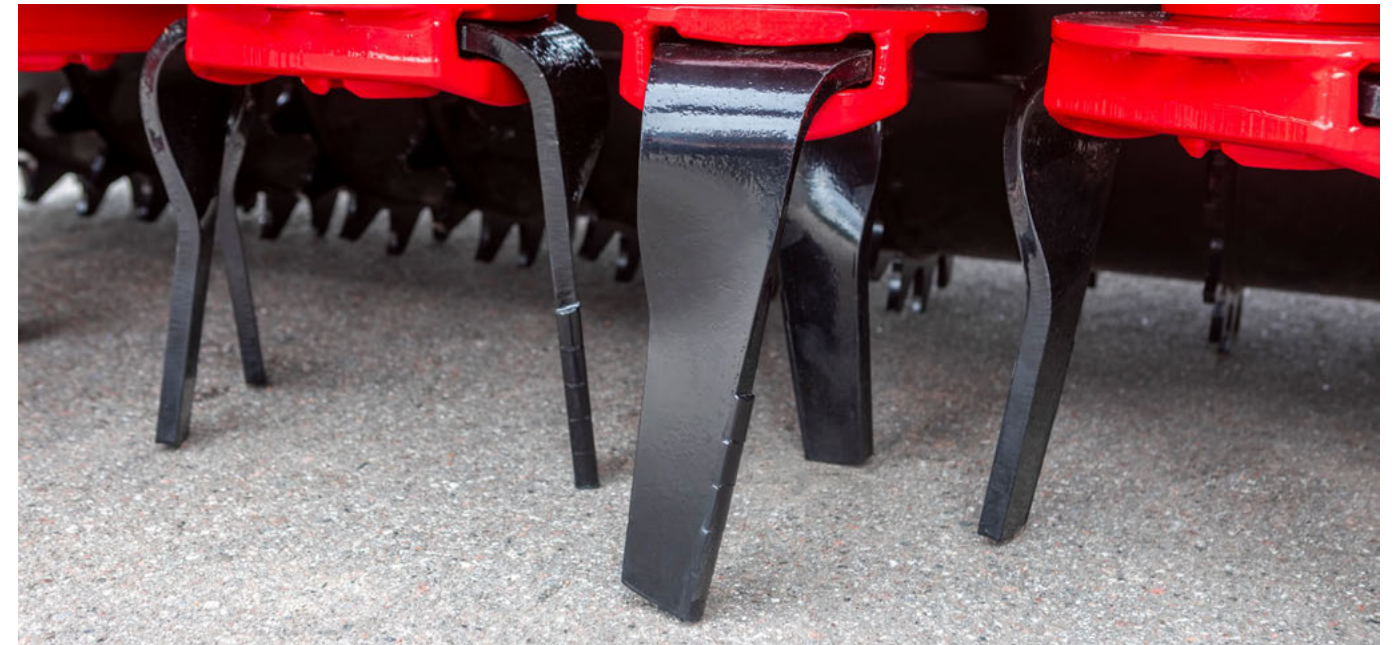
HM+ Zinken mit 130 mm Hartmetallbestückung im Schneidbereich bieten lange Standzeiten auf schweren Standorten mit Steinen
