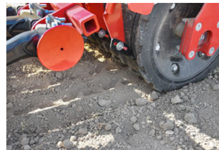
Der FarmFlex Packer vermindert Verkrustung durch streifenweise Rückverfestigung
