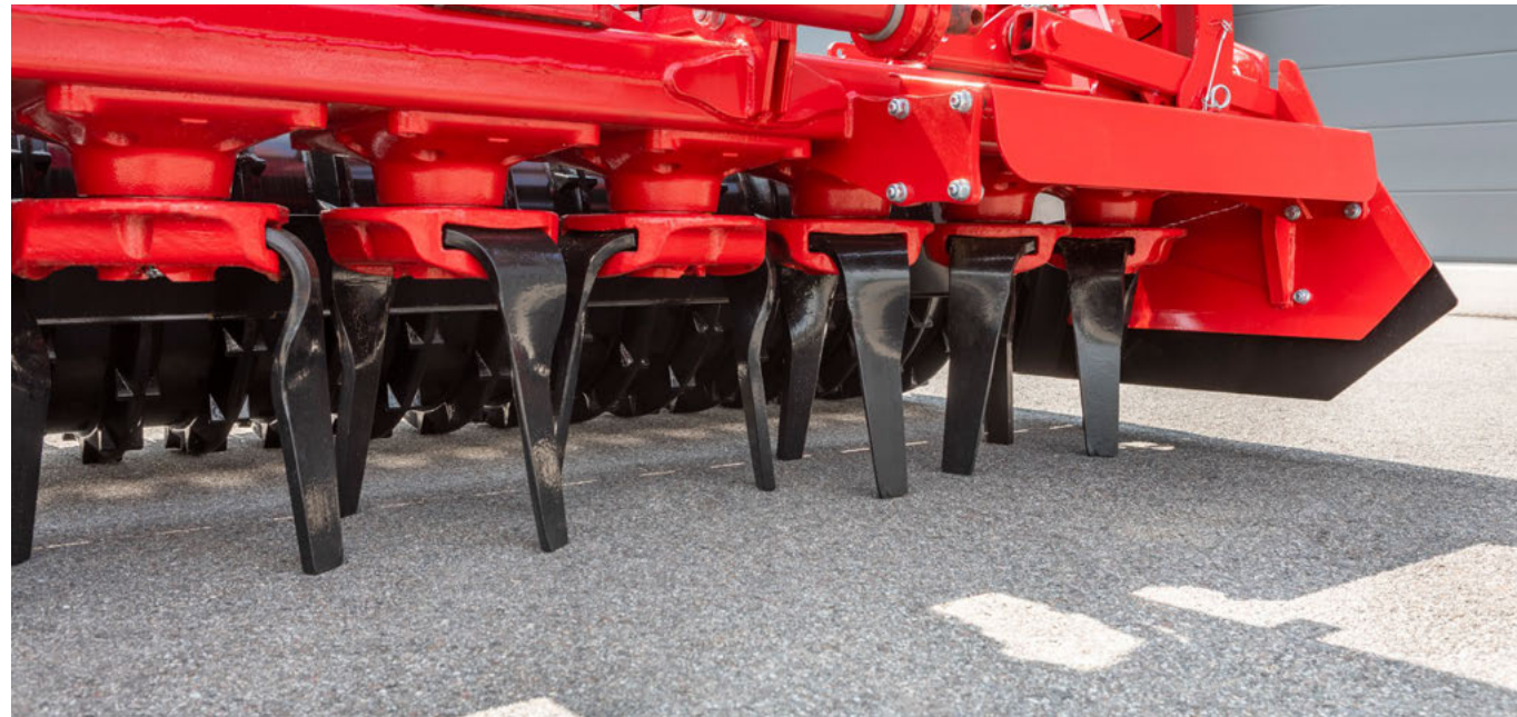
10 Kreisel für maximalen Durchgang bei 3 m Arbeitsbreite
