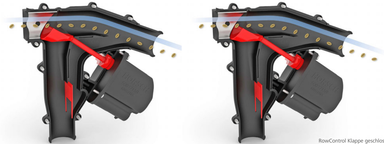
RowControl Klappe geschlossen: überschüssige Luft entweicht über das Schar, das Saatgut wird in den Injektor geleitet und dem Verteilerturm wieder zugeführt – keine Querverteilungsverluste
