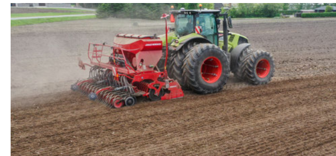
Der Doppeltank G&F ermöglicht es, zwei Komponenten getrennt zu dosieren und auf einem Horizont abzulegen.
