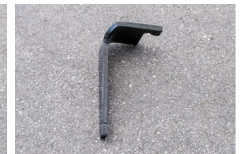
Zinken auf Griff machen aus der Kreiselegge einen Kreiselgrubber
