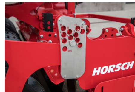
Gut sichtbare Arbeitstiefenverstellung der Versa SL über Steckbolzen
