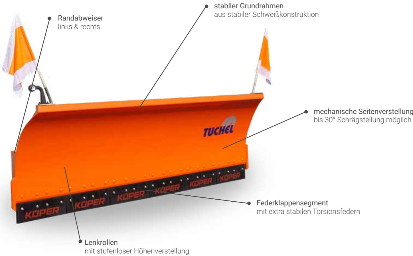
Das robuste Schneeräumschild SF hält selbst bei härtesten Wetterbedingungen stand und kann vor Radladern, Traktoren und Unimogs angebaut werden.
