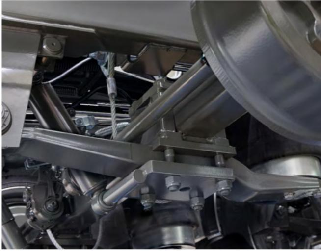
Verstärktes Einblattlenker Fahrwerk.
