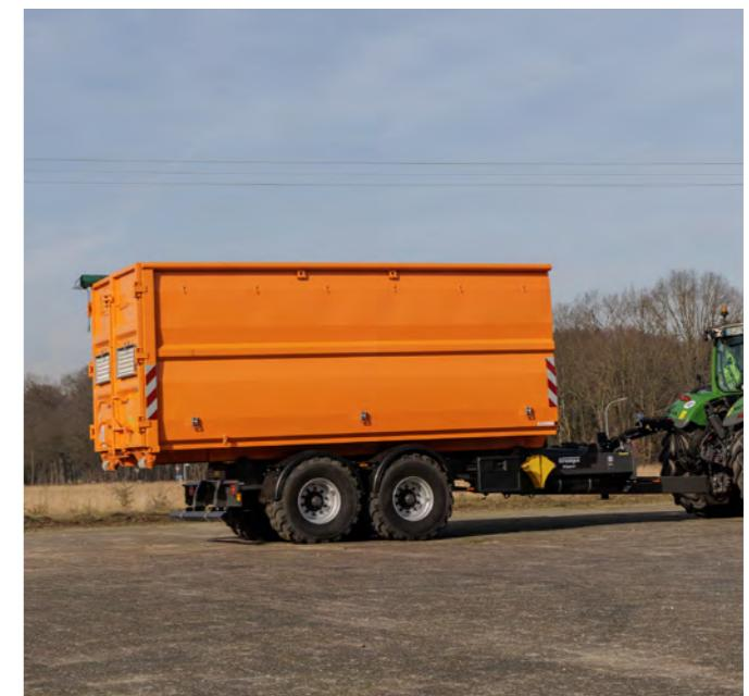
Die max. Container-Innenlänge beträgt beim THL 20 L Carrier 6,25 m, bei ausziehbarem Unterfahrschutz sind 6,75 m möglich.
