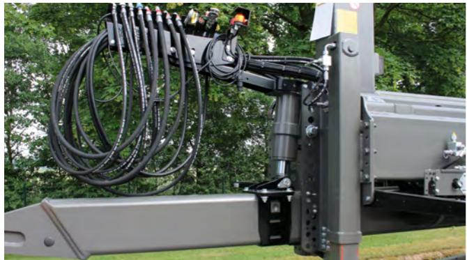
Die Zugvorrichtungen gibt es höhenverstellbar, mit Gummisilentblock oder Hydraulikzylinder.
