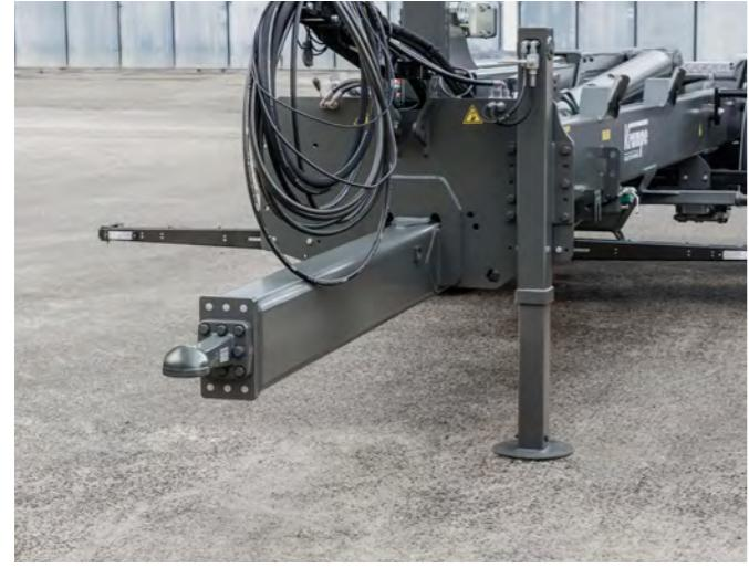
Unteranhängung mit K80, geeignet auch für den Anbau einer Zwangslenkung.
