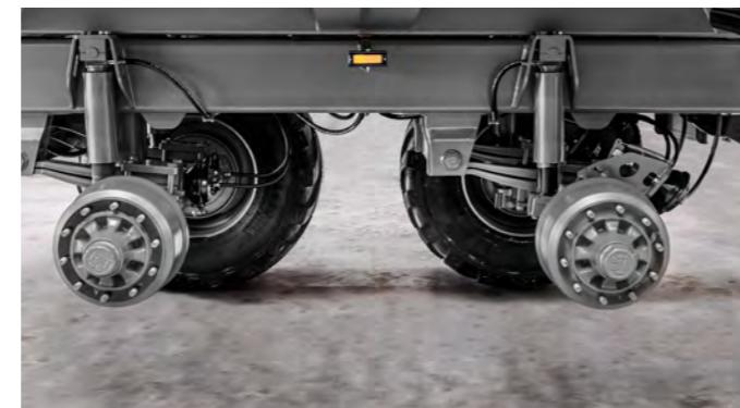
Auch Krampe liefert hydraulische Fahrwerke. Die serienmäßigen Schutzrohre verhindern Steinschlag auf den doppelt-verchromten Kolbenstangen.
