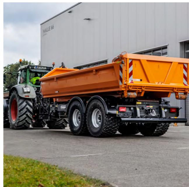
Die max. Container-Innenlänge beträgt beim THL 16 L Carrier 5,50 m, bei ausziehbarem Unterfahrschutz sind 6,00 m möglich.
