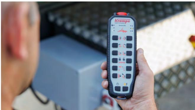
Mit der Funk-Fernbedienung können die Hauptarbeitszylinder, der Schubarm und die hydraulische Containerverriegelung bedient werden.
