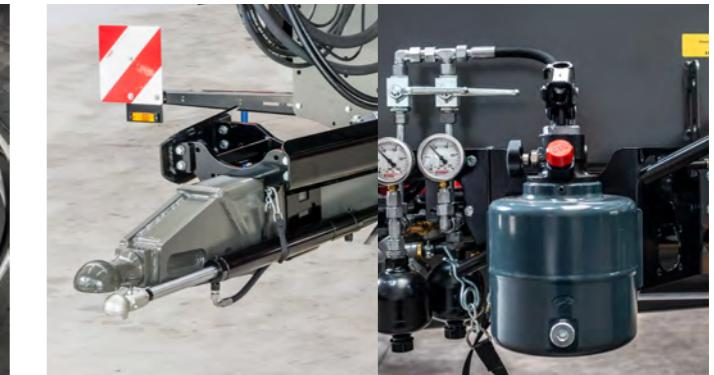
BPW Zwangslenkung: dw-Geberzylinder befindet sich vorne an der Zugvorrichtung, Fahrtrichtung links & rechts beim Tridem, hydr. Anlage komplett mit Handpumpe, Manometern und Stickstoffspeichern, Kopplungspunkte am Schlepper nach dem Normvorschlag (ISO 26 402)
