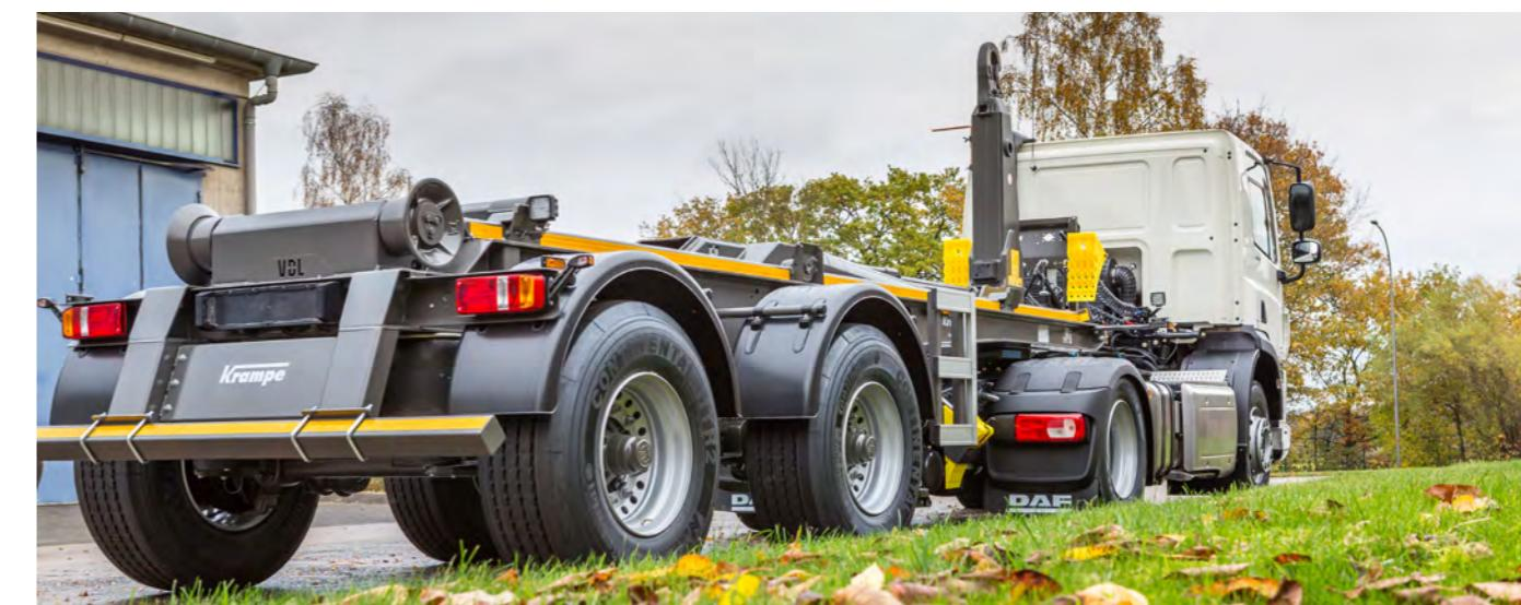
Sattelauflieger-Hakenlift (Abrollkipper): Das flexibel einsetzbare Fahrzeug für Sattelzugmaschinen.
