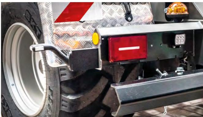
Die großen LED-Rückleuchten sind in einem massiven Schutzgehäuse untergebracht, seitliche Positionsleuchten im Heck dienen dem Fahrer zur besseren Übersicht und erhöhen die Verkehrssicherheit.
