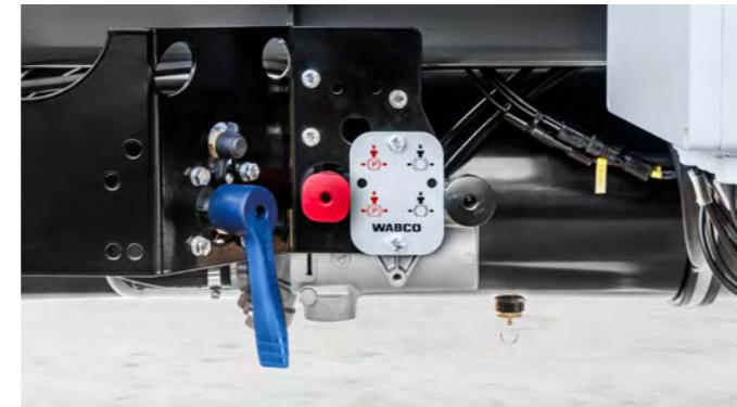
EBS Anlage mit einem serienmäßigem eTASC Ventil. Hiermit können auch Fahrhöhen eingestellt und gespeichert werden.
