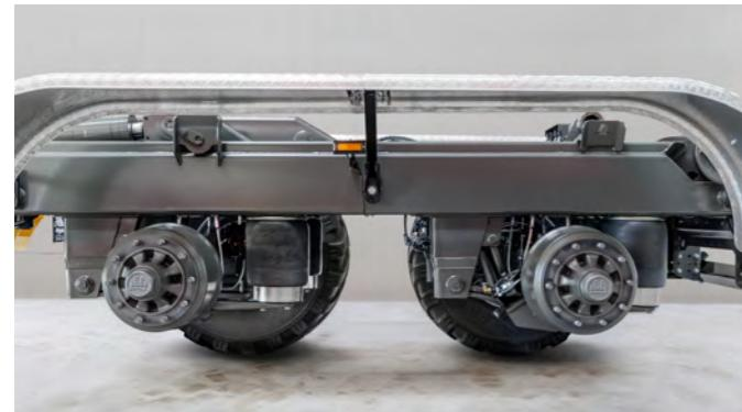
Das Luftfahrwerk ist ausgerüstet mit Zweiblattlenker und Luftbälge mit einem Durchmesser von 360 mm. Diese Kombination sorgt für ein extrem gutes und stabiles Fahrverhalten.
