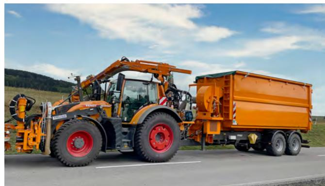
Volumencontainer mit Einblasöffnung für den Transport von Gras schnitt, welcher von der Straßenbankette gemäht und anschließend abgesaugt wird.
