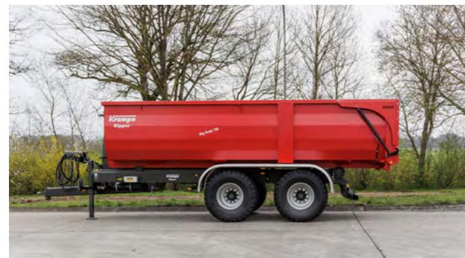
Der THL 21 L mit serienmäßigem Luftfahrwerk kann auf Wunsch mit einer Lenkachse und einem Achsabstand von 1,81 m für 24 t zulässiges Gesamtgewicht bei 40 km/h geliefert werden. Für dieses Modell sind viele weitere Sonderausstattungen verfügbar.
