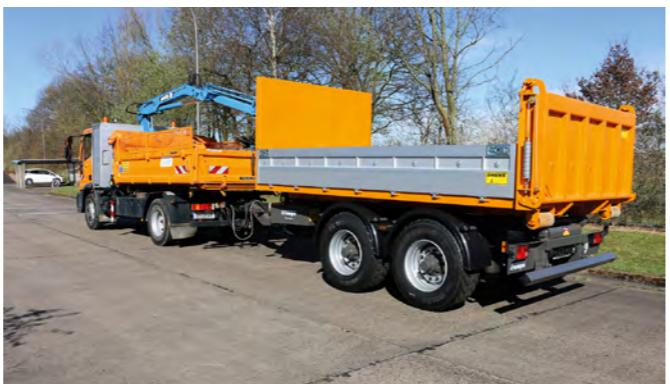
Kommunalcontainer mit seitlich abklappbaren Alubracketen und überfahrbahrer Pendelheckklappe.
