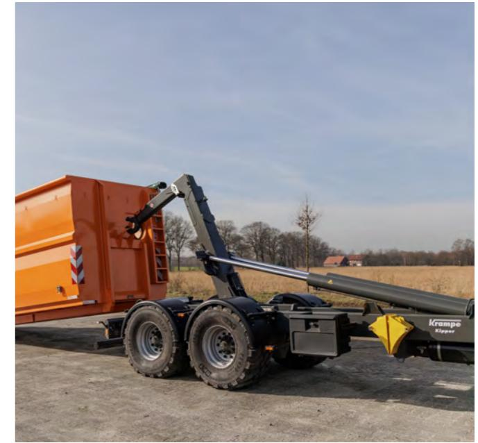
Durch den Verzicht auf einen zusätzlichen Hilfsrahmen verringert sich der Aufzugsinkel und die Aufzugsleistung steigt.
