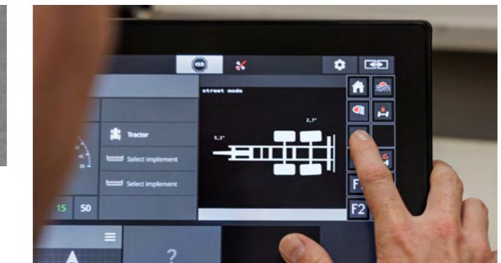
Mittels ISOBUS-Steuerung haben wir die Bedienung über das Terminal der Zugmaschine für die Zwangslenkung realisiert.
