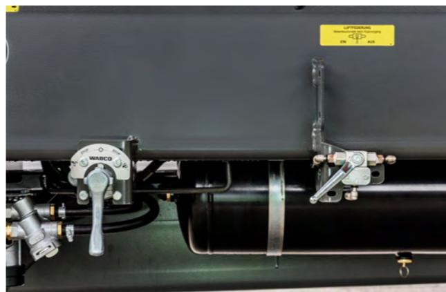
Optional - Ventil Heben/Senken. Serienmäßig mit Umschalthahn für die Luftfederung.
