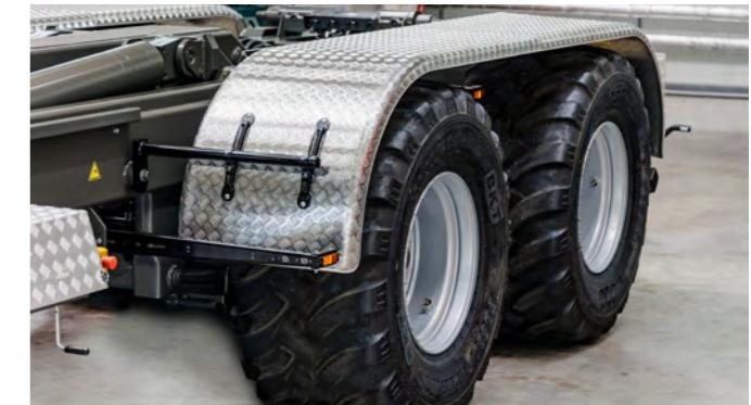
Alu-Kotflügel für Breitreifen und Lenkachsen.
