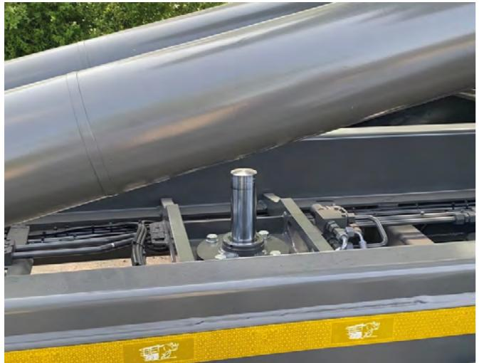
Der Ankipp-Hilfszylinder (Startzylinder) erleichtert das Kippen der Behälter im abgesenkten Zustand. Das ist besonders sinnvoll, wenn ein kurzer Überhang beim Kippen gewünscht wird.
