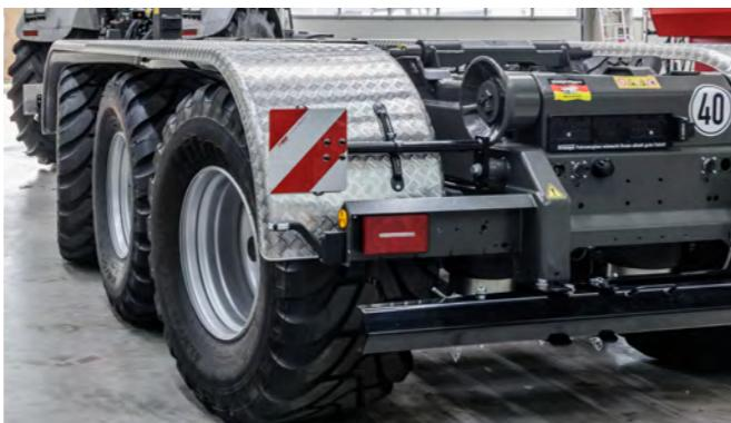
Serienmäßig werden unsere Tridemhakenliftanhänger mit einer Nachlauflenkachse gebaut, zu empfehlen ist aber eine Zwangslenkung.
