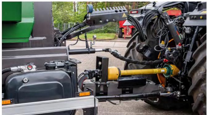
Für alle Abrollkipper bis 25t Hubkraft reicht die Schlepperhydraulik (200bar) aus. Eine eigene Ölversorgung mit Zapfwelle ist auf Wunsch lieferbar. Als Option kann eine Funksteuerung bestellt werden.
