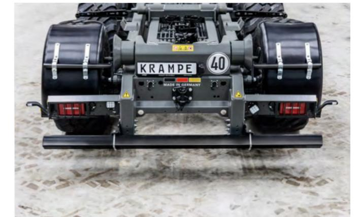
Ein aufgeräumtes Heck für Öl Anschlüsse hinten und eine Anhängerkupplung.
