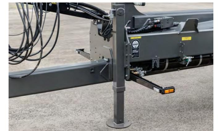
Hydraulischer Stützfuß, serienmäßig mit einem 6/2 Wegeventil kombiniert mit der hydraulischen Containerverriegelung.
