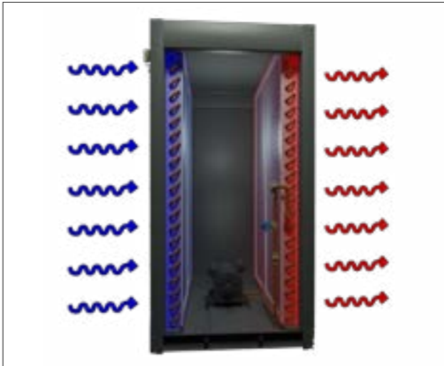
Schema: Kreislauf des Kältemittels. Der Verdampfer (blau) ist kalt und der Kondensator (rot) ist warm.
