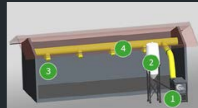
(1) Warmlufterzeugung, (2) evtl. Pelletsilo, (3) Temperaturfühler, (4) Warmluftschlauch
