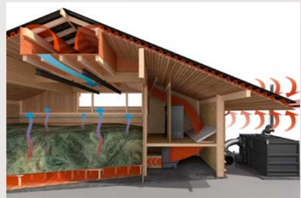
System Trocknen mit Dachabsaugung
