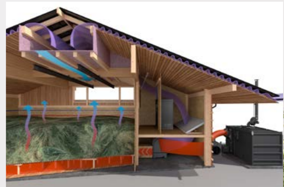
System Trocknung mit Warmluft und Dachabsaugung
