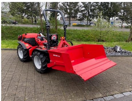
Benne basculante MEC , attelage à 3-points, cat I, couvercle relevable ou rabattable, basculement mécanique
