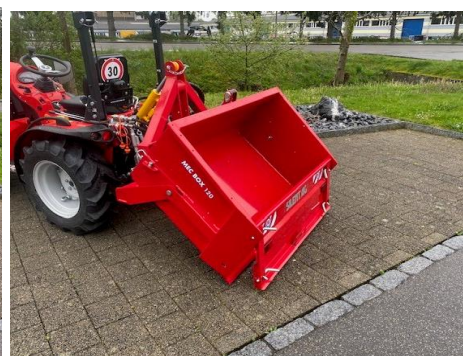
Benne basculante MEC , attelage à 3-points, cat I, couvercle relevable ou rabattable, basculement mécanique
