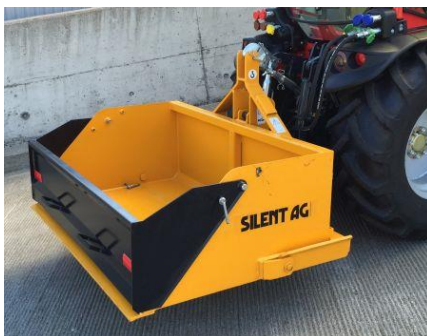
Benne basculante RI , attelage à 3-points, cat I, couvercle rabattables, basculement hydraulique
