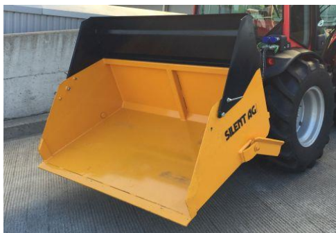
Benne basculante RI , attelage à 3-points, cat I, couvercle rabattables, basculement hydraulique
