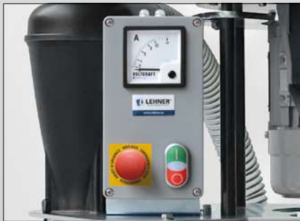
Steuereinheit mit An/Aus, Not-Aus und Ampere-meter des Entspelzermotors zur Überwachung der Stromaufnahme (Soll: 4 – 6 A).
