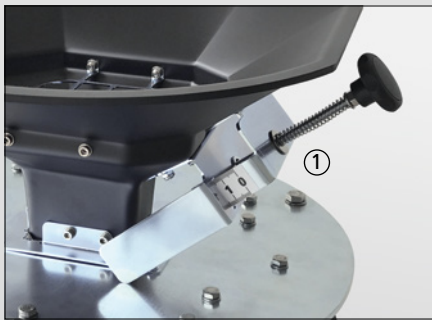
Regelung der Dosiermenge und Lockerung des Füllguts via federgelagertem Dosierschieber ①.
