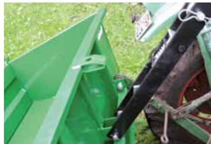
dispositif de basculement mécanique
