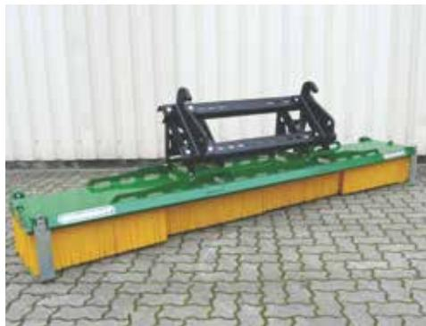
Support D-LOCK (avec support Schäffer monté)
