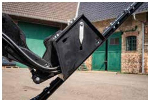
Indicateur d'angle intégré pour une précision maximale
