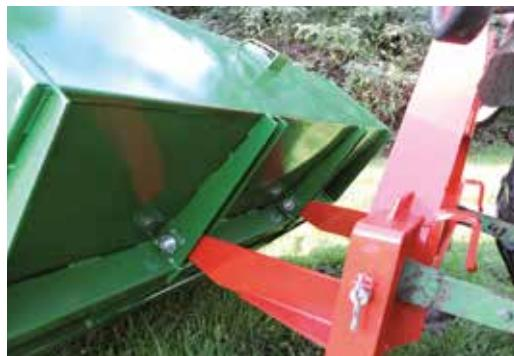
dispositif de basculement mécanique
