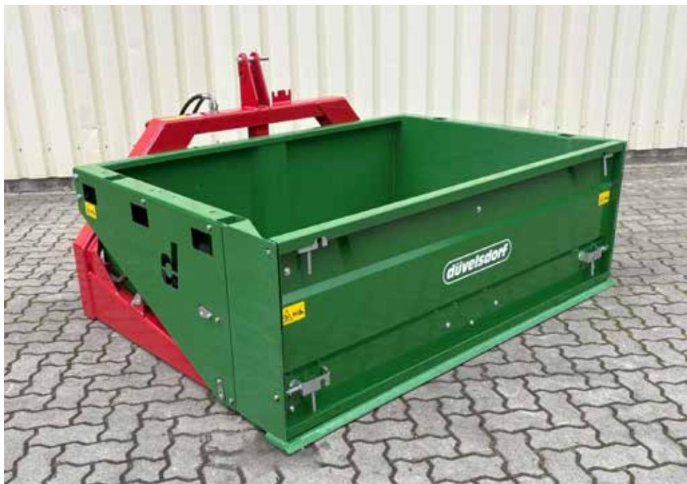
Le conteneur arrière HD convient aux utilisations lourdes. Avec une capacité de charge de 2,5 t et des dimensions intérieures de (L x P x H) 1805 x 1240 x 600 mm, le conteneur arrière convient au transport de deux palettes EURO avec le volet fermé.
