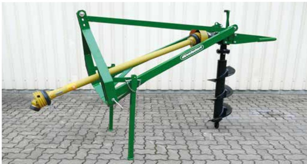
La tarière de Düvelsdorf est livrée avec une broche de perçage. Vous avez le choix entre des corps de forage d'un diamètre de 150 mm, 300 mm ou 450 mm. Les broches de perçage sont équipées de lames de coupe remplaçables. L'arbre de transmission fourni est équipé d'un accouplement à friction. Il entraîne la transmission à bain d'huile. La profondeur de perçage est de 100 cm. La construction permet un rangement sûr et peu encombrant, ainsi que l'attelage et le dételage du tracteur.
