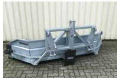
La racleur en caoutchouc oscillante convient au poussage de panneaux de silo, de passerelles et d'autres surfaces. L'articulation pendulaire assure un appui uniforme sur le sol et ainsi un résultat optimal. Les ailes faisant saillie vers l'avant et le rehaussement de la tôle assurent un volume de poussée élevé.
