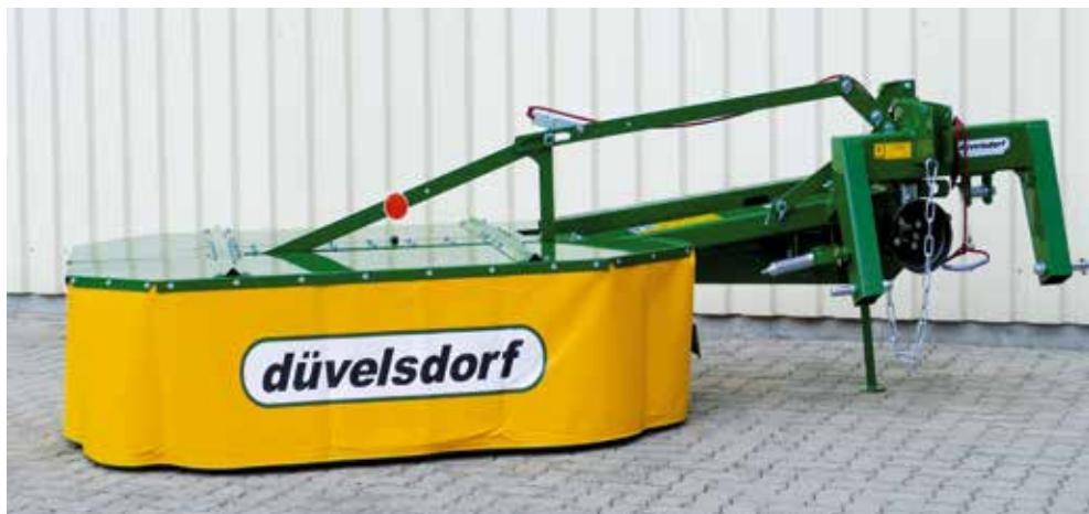
Les faucheuses à tambours de düvelsdorf **dcut** sont conçues pour être utilisées dans tous les pâtrages et champs. Cette faucheuse convient à toutes les dimensions d'exploitation, que ce soit comme deuxième unité pour les grandes exploitations, comme unité simple à titre d'accessoire ou pour les petites exploitations. Pour effectuer un basculement en position de transport, il faut retirer l'arbre de transmission.
