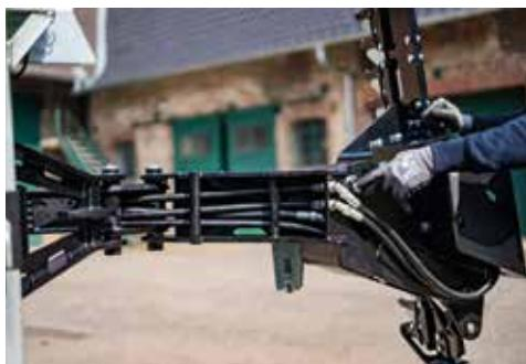
Pose des tuyaux protégés dans le châssis
