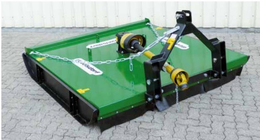
Gyrobroyeur avec arbre de transmission et chaînes de tension
