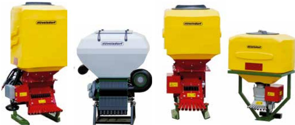
Les dispositifs de semis sont disponibles en différents modèles afin de pouvoir proposer la machine adaptée à chaque emploi. Il existe des différences dans le nombre de sorties et leurs diamètres ainsi que dans l'entraînement du ventilateur et le débit qui en résulte.
