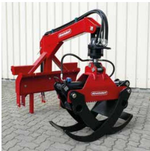
Le grappin forestier avec rotateur convient à l'empilage et au déplacement des troncs d'arbre. Le rotateur sans fin avec une capacité de charge de 4,5 t et la pince avec une largeur d'ouverture de 1 560 mm permettent un travail confortable. Le montage peut se faire aussi bien avec la prise EURO sur le chargeur avant qu'en trois points avec la prise CAT 2.
