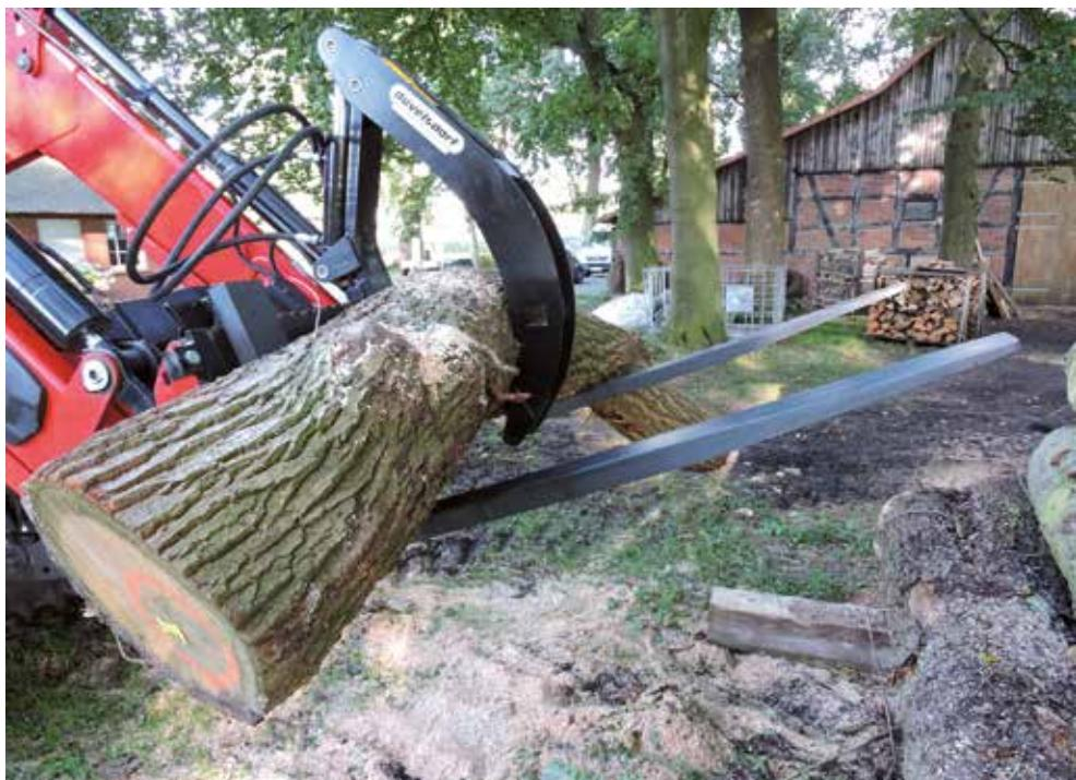
Le grappin supérieur est utilisé comme accessoire pour la fourche à palette avec dispositif de chargement FEM II ISO ou DIN et est utilisé pour le chargement des grumes.
