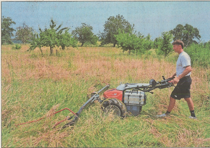
Mit 3,1 m Arbeitsbreite mähnt Thomas Küpfer mit dem Aebi CC 140e grössere Flächen. Unter dem Holm sind die Akkupacks mit Zugriemen befestigt.
