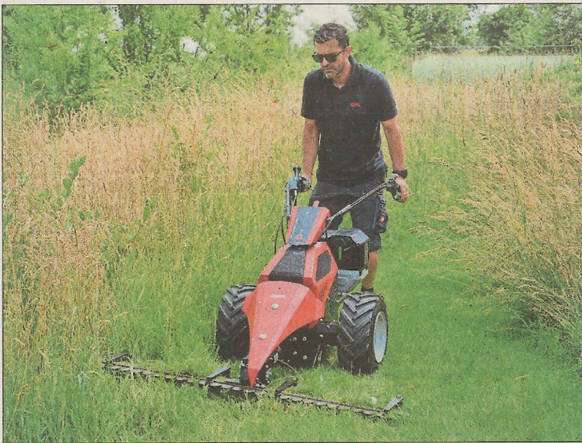
Der Köppl Kompakt Easy e-Drive mähnt hier mit einem 1,62-m-Messerbalken. Matthias Seiler schneidet damit nah an die Wildfruchtsträucher heran.
