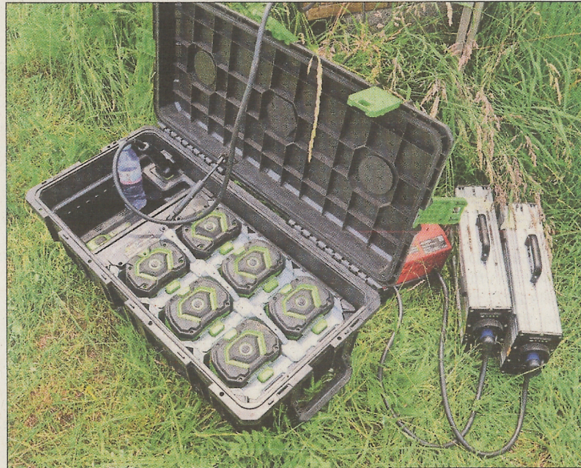
Links der Ladekoffer für Ego-Akkus, wie sie im Köppl Kompakt Easy e-Drive verwendet werden, und rechts die Akkus des Aebi CC 140e.
