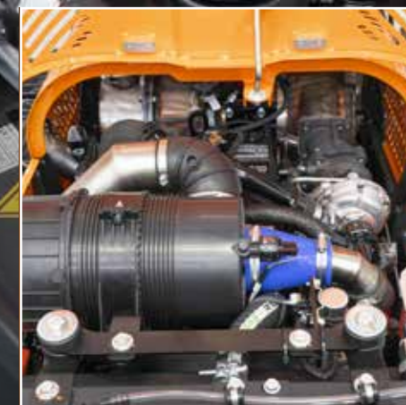
60-PS-MOTOR VON YANMAR, STUFE V
