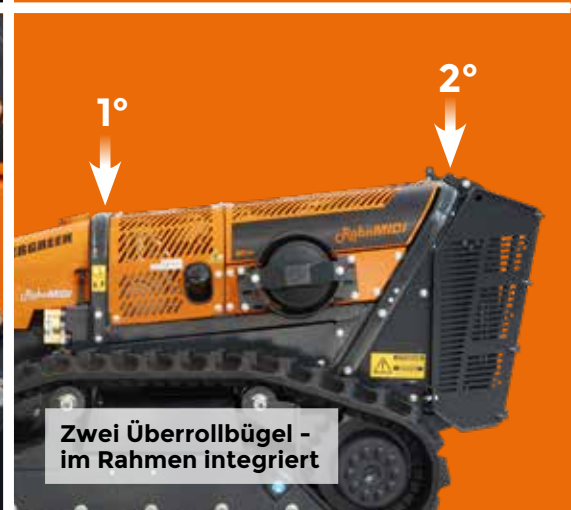
Automatische, hydraulische Spannung der Laufbänder
