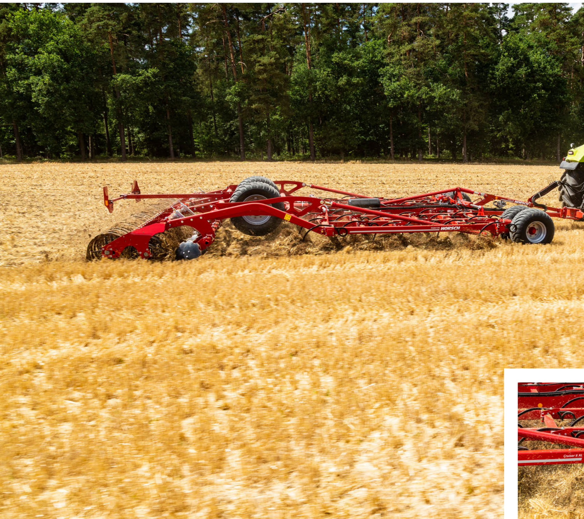
HORSCH Federzinken mit 150 kg Vorspannkraft
