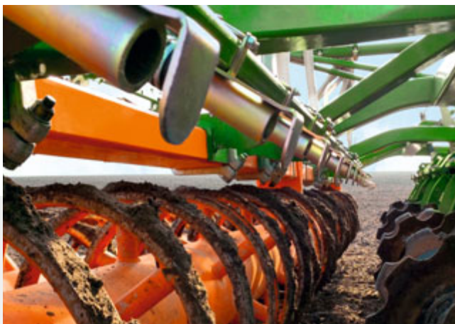
Saatgut-Prallteller für die oberflächliche Ausbringung vor der Walze
