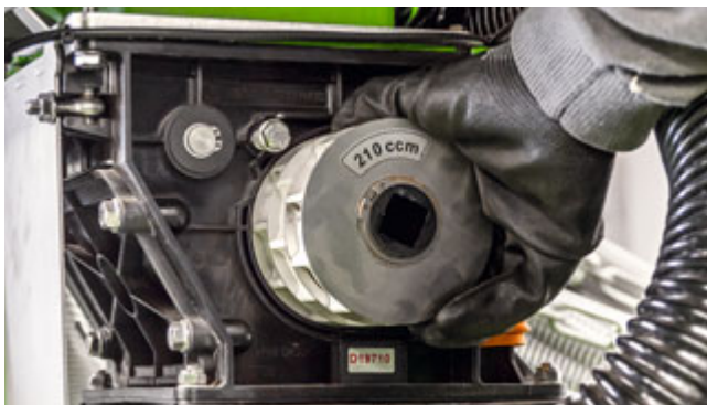
Einfacher Wechsel der Dosierwalze
