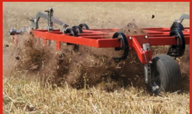
Die aggressiven Federzinken ziehen sich selbst in den Boden ein, unabhängig vom Gewicht des Geräts.
