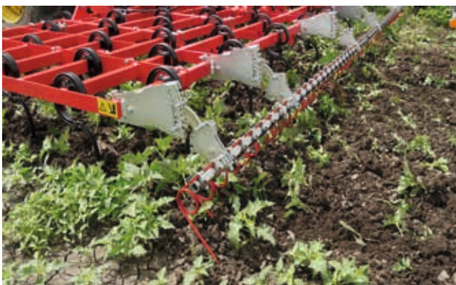
Die Super Maxx® Zinken lösen den Bewuchs. Der Striegel legt das Unkraut an der Oberfläche ab, wo es vertrocknet.
