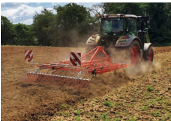
Mechanische Unkrautbekämpfung mit dem Super Maxx® 30-7 BIO.
