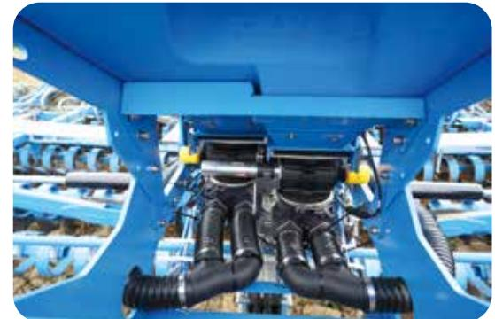
Pour une **distribution transversale exacte dans le flux de terre**, et sur toute la largeur de travail - même lorsque les conditions météorologiques sont défavorables -, la semence est transportée par la turbine à entraînement hydraulique vers les têtes de distribution des différents tronçons, puis vers les diffuseurs.
