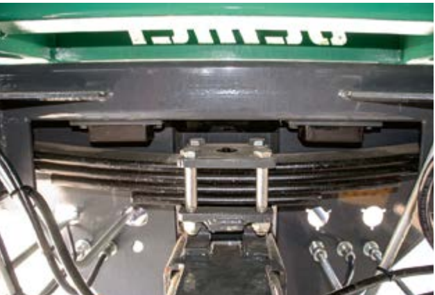
Gefederte Zugdeichsel bis max. 4 t Stützlast
