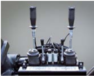
Kreuzhebelsteuerung 6-fach mechanisch, 2-fach elektrisch
