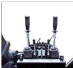
Kreuzhebelsteuerung 6-fach mechanisch 2-fach elektrisch
