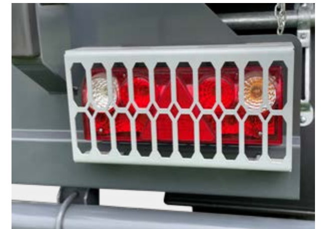
Beleuchtung ab ZDK 180 bis DDK mit Schutzgitter
