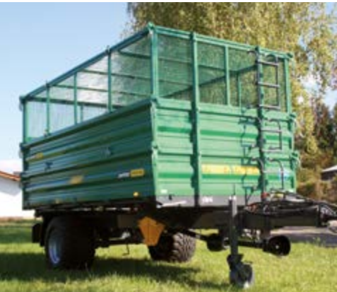
OL EDK 70 mit Laubaufsatz für Laubsauger
