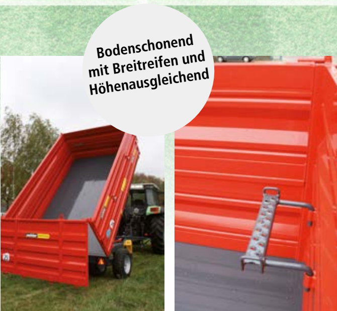
OL EDK 60 SG 1000mm pendelbare Rückwand
