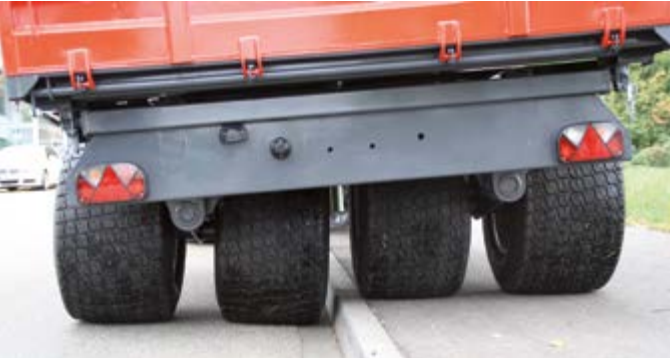
OL EDK 60 SG Höhenausgleich durch Pendelachse
