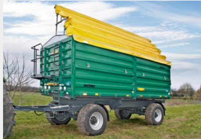
OL ZDK 180 mit hydraulischem Cabriooverdeck
