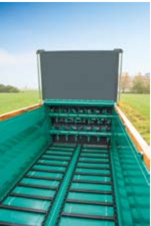
Kratzbodenleisten Hydraulischer Stauschieber
