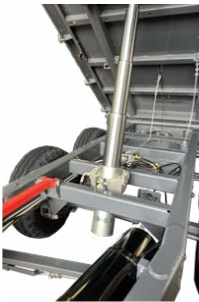
Stabiler Unterbau und Rechteckrohrrahmen
