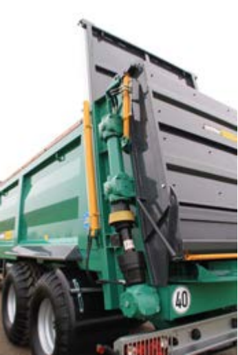
Antrieb über Kardanwelle
