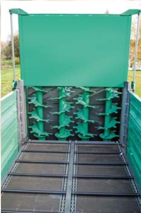
Kratzbodenleisten Hydraulischer Stauschieber
