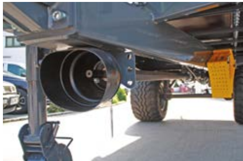
Zapfwellenanschluß für Streuteller
