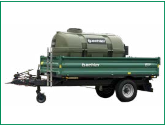
OL EDK 60 mit Bewässerungstank
