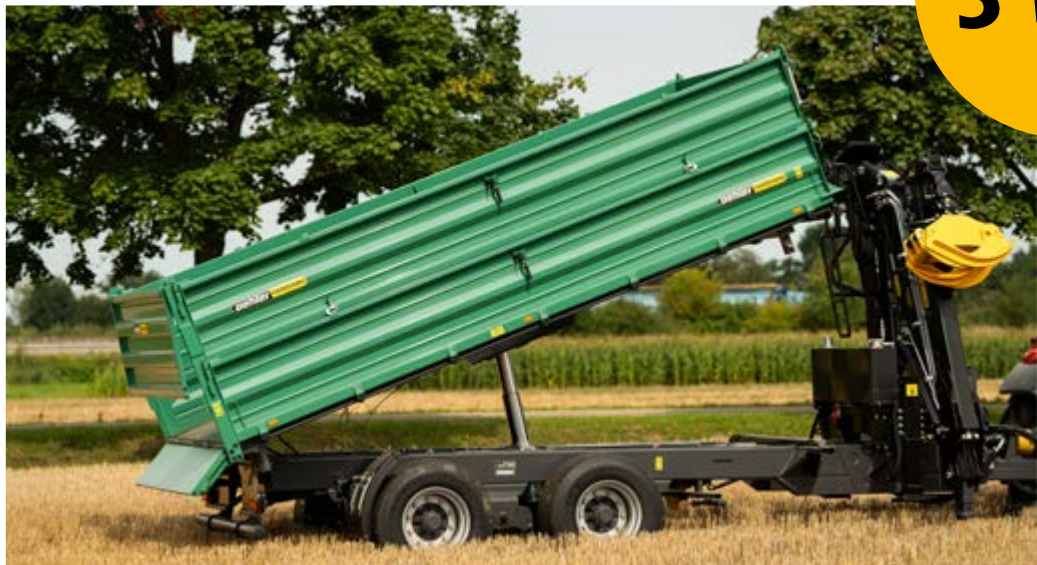
3-Seitenkipper mit 16t zul. Gesamtgewicht, Schotterklappe optional
