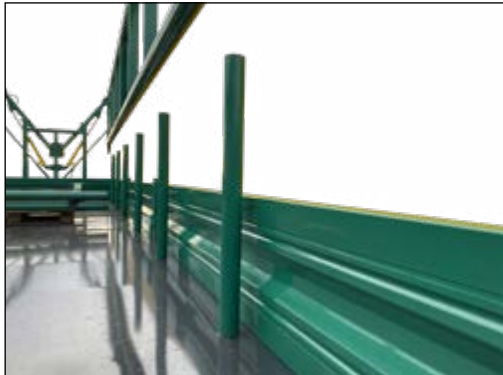
Bordwände, Rungen, hydraulische Klemmgatter
