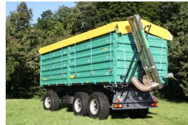
OL DDK 240 mit zusammengeklappter Kornschnecke
