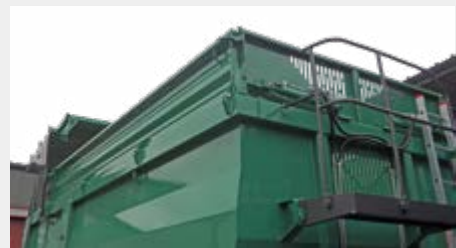
Hydraulisch abklappbarer Aufsatz
