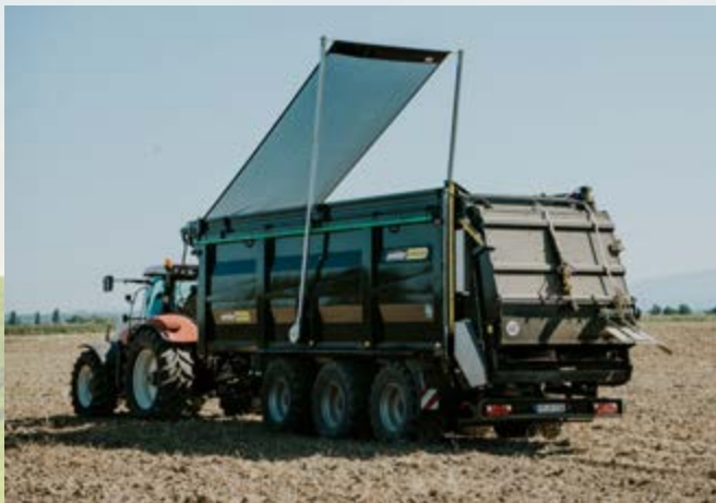
ASW 340 B - Breitstreuwerk und Flip-Tarp Netzabdeckung
