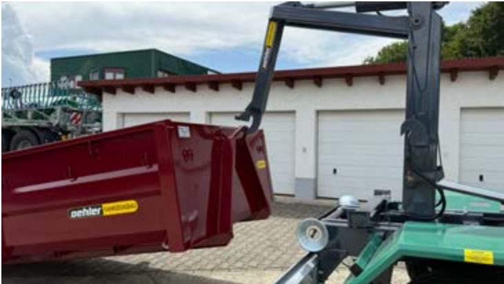
OL EHKL 80 Position Containeraufnahme
