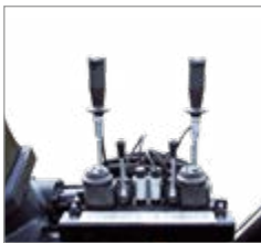
Kreuzhebelsteuerung 6-fach mechanisch 2-fach elektrisch
