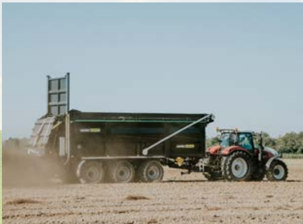
ASW 340 B - Breitstreuwerk und hydraulischer Stauschieber
