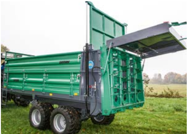
OL STT 80 mit Stauschieber + hydraulischem Streuschutz
