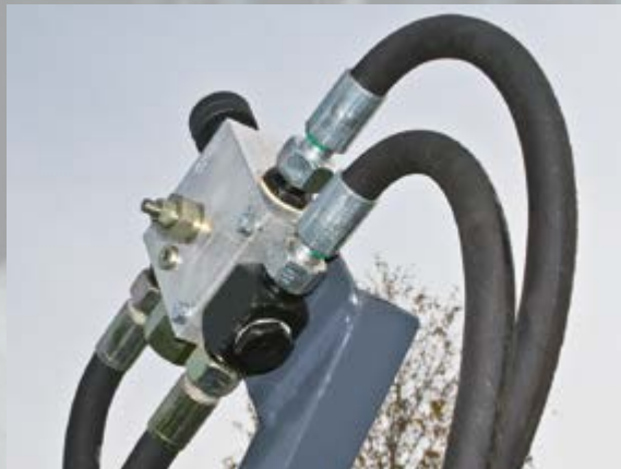
Stufenlose Einstellung Vor- und Rücklauf vom Kratzboden
