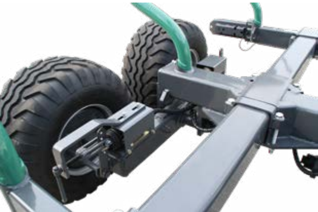
Einrohrrahmen mit verstellbaren Rungen
