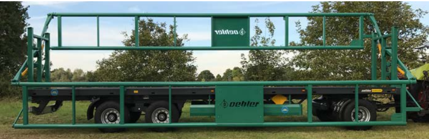
OL DDK 240 BL - LOAD FIX / Dreiachs-Ballenwagen mit Ladungssicherung
