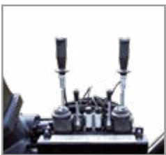
Kreuzhebelsteuerung 6-fach mechanisch 2-fach elektrisch
