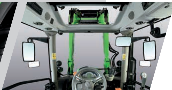
> 4-Säulen-Kabine mit guter Sicht, bereit für Frontladereinsätze.
