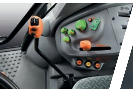
> Elektronische Hubwerksregelung mit aktiver Schwingungstilgung.
