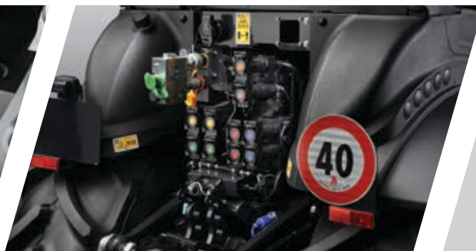
> Mittig angeordnete Hydraulikanschlüsse für Frontgeräte.
