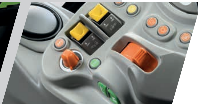
> Elektrohydraulische Zuschaltung der Front- und Heckzapfwelle und Zapfwellenautomatik.
