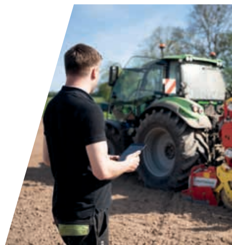
> XTEND-Funktion mit Tablet, Steuerung von Anbaugeräten über ISOBUS UT, während Sie sich außerhalb der Kabine befinden.
