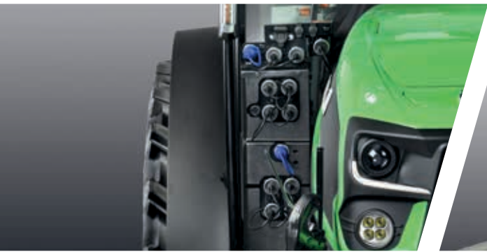
> separate Zusatzsteuerventile im Zwischenachsbereich verfügbar
