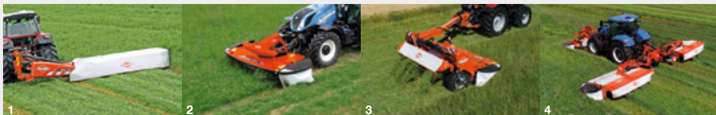
1. Faucheuses portées arrière - 2. Faucheuses frontales - 3. Faucheuses à disques traînées - 4. Faucheuses à disques combinaisons triple
