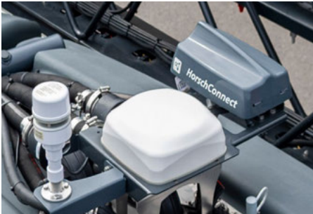
Digitale Vernetzung mit HorschConnect, GPS und einer Wetterstation zur optimalen Anpassung an aktuelle Umweltbedingungen
