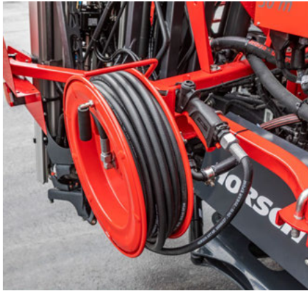
Schlauchtrommel zur Außenreinigung
