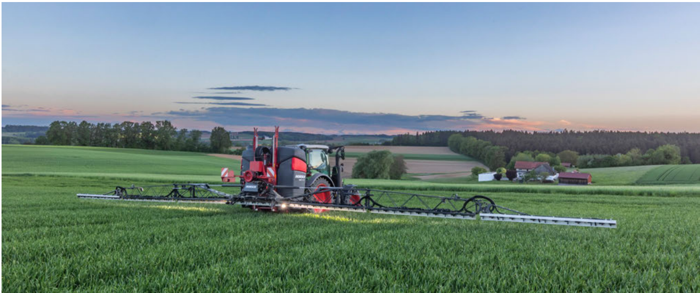
Éclairage des buses de pulvérisation grâce au NightLight
