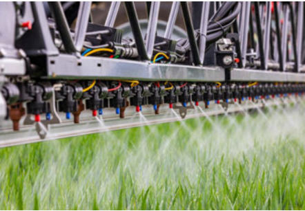
Écartement des buses de 25 cm : plus de buses, plus de possibilités, par exemple application 3D.
