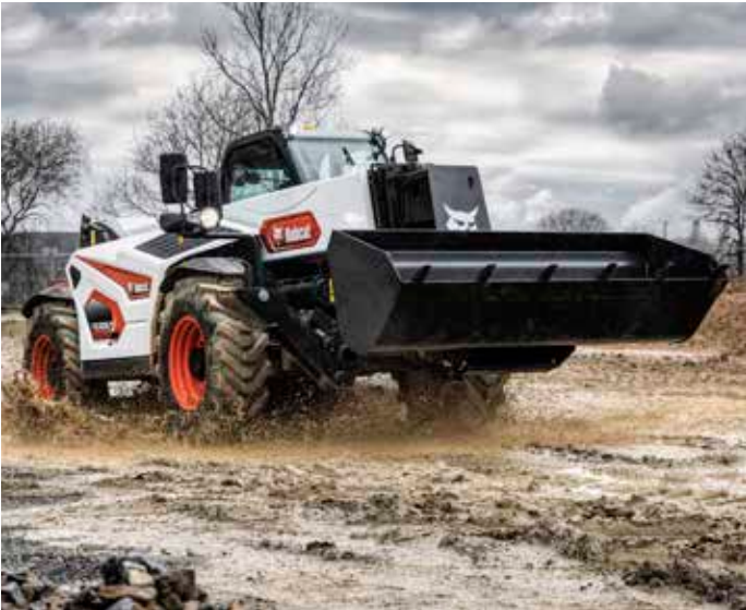
Ein serienmäßiges Hydrostatikgetriebe mit dynamischem Modus sorgt bei allen Modellen für mehr Wendigkeit.
