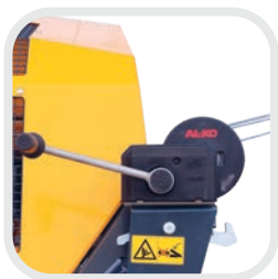
Inclinaison à l'aide d'un treuil mécaniquement réglable.
