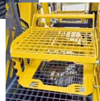
Höhenverstellbare Podeste, frei positionierbar
