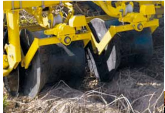
Dammtrommeln aus Kunststoff, hydraulisch angetriebenes Scheibensech außen
