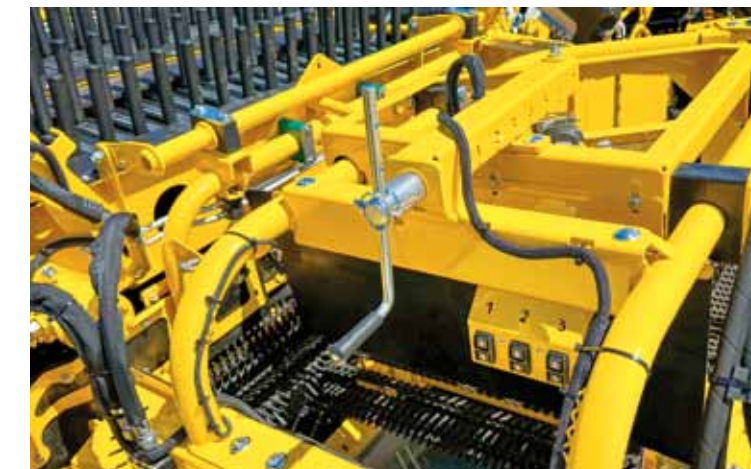
Horizontale Verschiebung der Ableitwalzen am Igel 3
