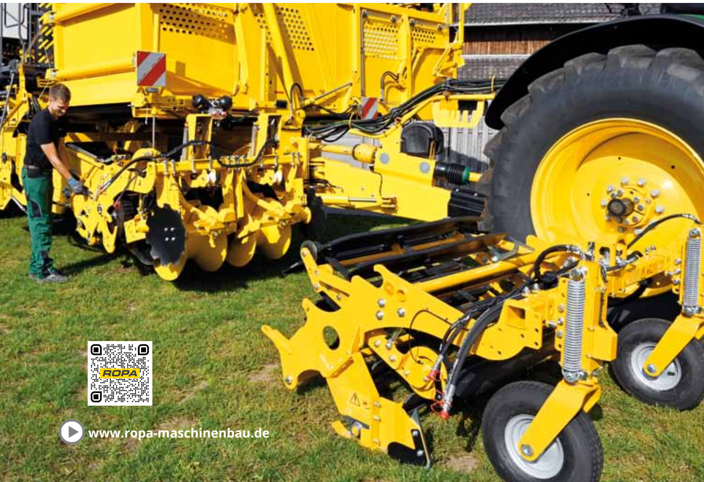
Dammaufnahme mit beidseitig gezackten Hohlkreisen
