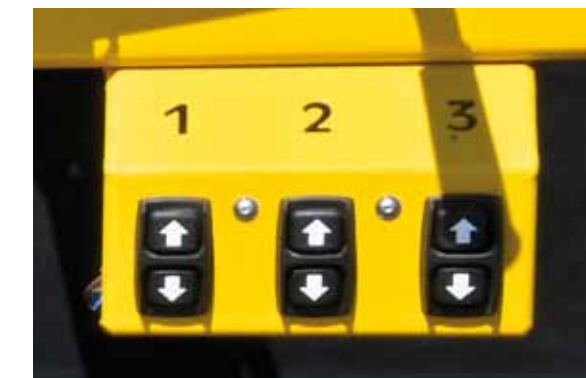
Höhenverstellung der Ableitwalzen mittels Linak Linearantriebe
