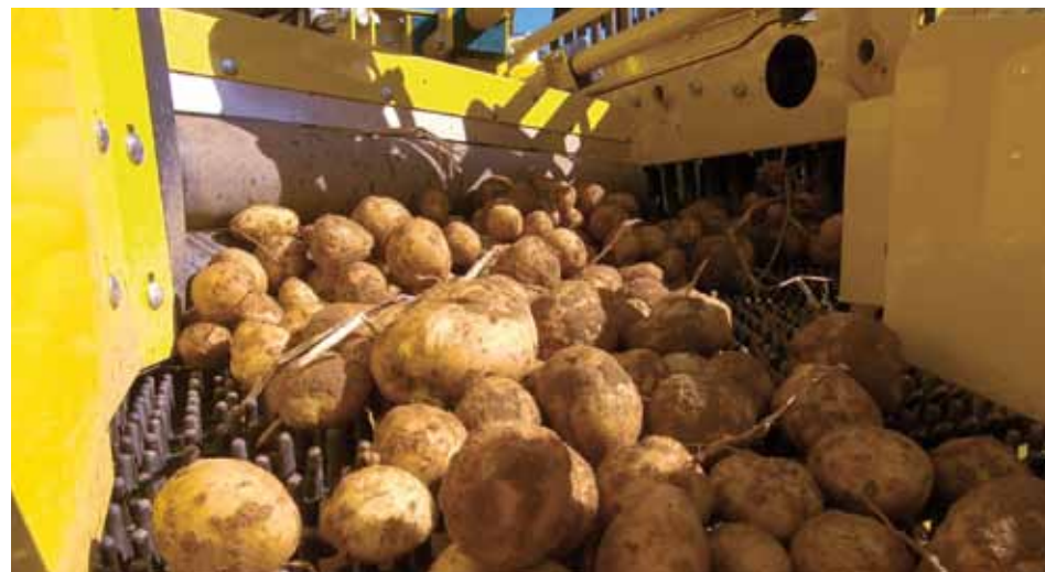
Übergang Igel 3 auf 4
