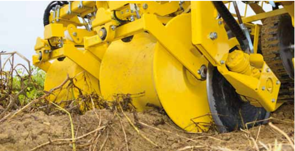
Bis zu 4 hydraulisch angetriebene Scheibenseche (2x innen, außen links und rechts)
