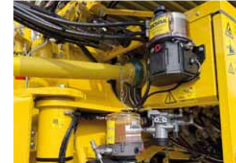
Zentralschmieranlage und Kettenöler
