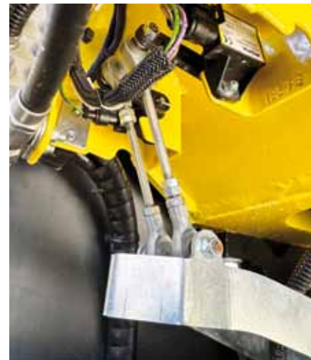
Potentiometer untereinander austauschbar, dadurch höhere Einsatzsicherheit und geringere Vorhaltung von Serviceteilen
