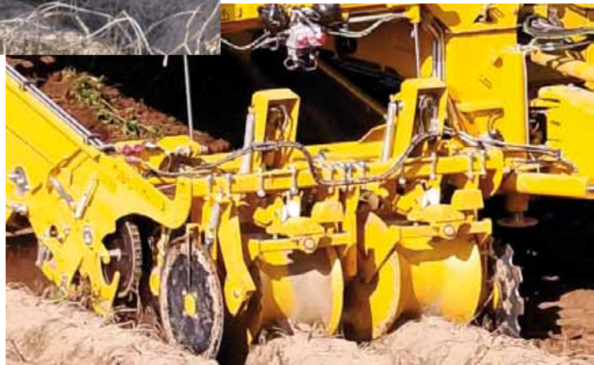
Gezackte Hohl­scheibe innen, zusätzliches Scheibensech außen
