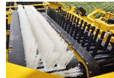
Gemischter Fingerkamm und Bürstenkamm
