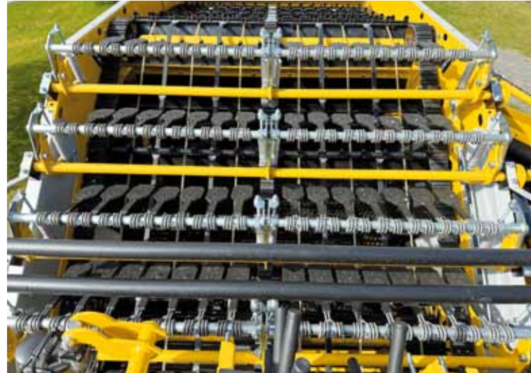
Verbesserter Krautkettenverlauf und Krautrückhaltefedern
