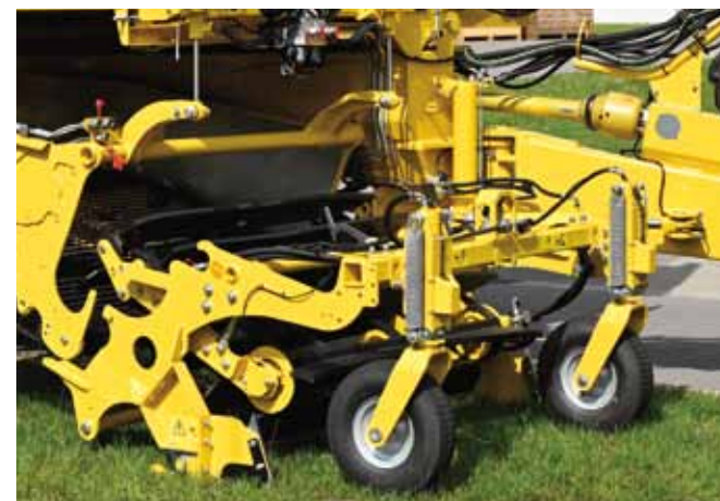
Dammaufnahme mit beidseitig gezackten Hohlkreisen
