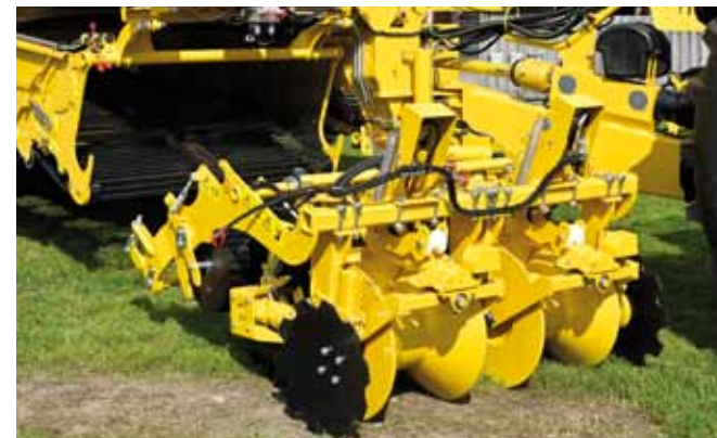
Dammaufnahme mit beidseitig gezackten Hohlkreisen
