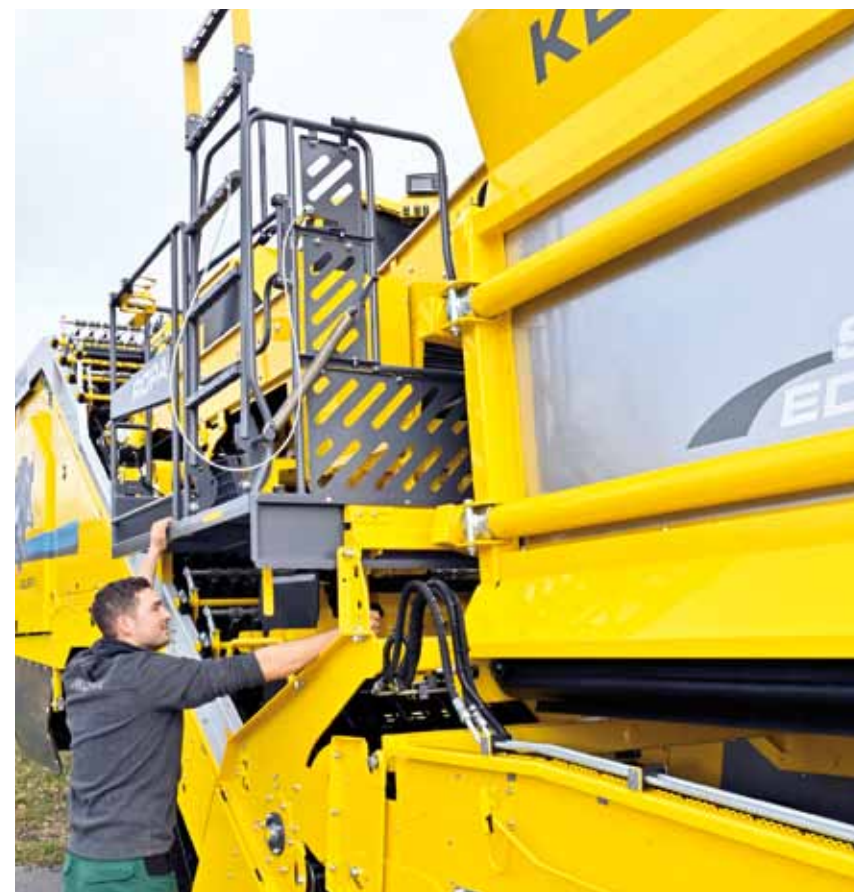
Arbeitspodest, 300 mm ausschiebbar - großzügige Arbeitsfläche für mehr Bewegungsfreiheit
