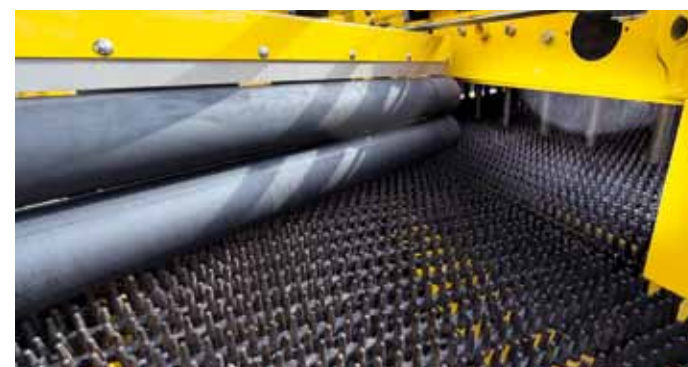
Übergang Igel 3 in umlaufenden Fingerkamm
