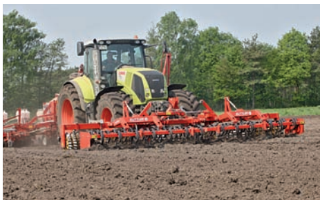
Avant SX 610-56 U mit Zinkenvorsatz zur Maissaat
