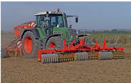
Avant SX 610-56 U mit Einebnungs- striegel zur Zinkensämaschine
