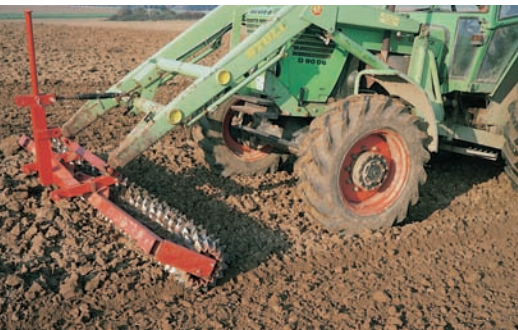
Anfänglich erfolgte der Anbau oft auch am Frontlader
