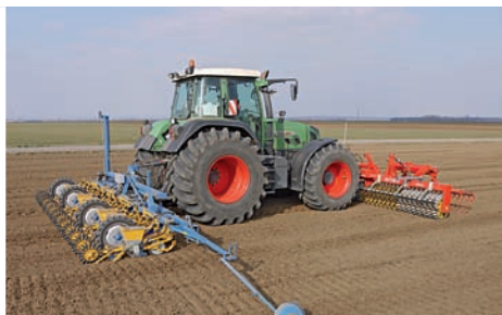
Avant SX 610-56 U mit Einebnungs- striegel zu Rüben oder Raps
