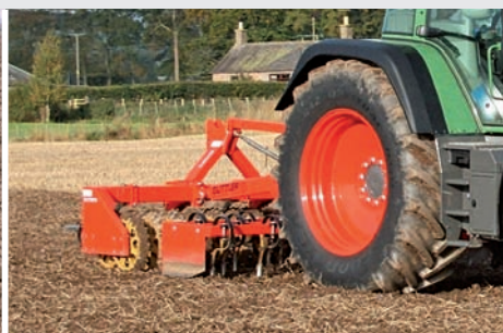
DX 30-56 mit Zinkenvorsatz und Heck-Dreipunktturm zur Saatbettbereitung
