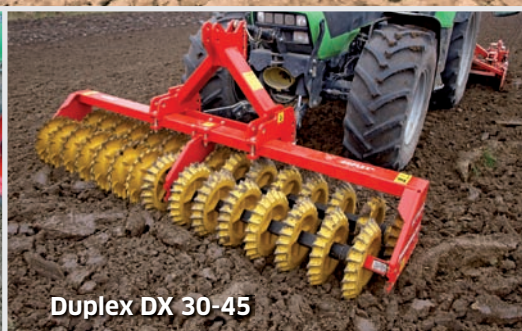
Duplex DX 30-45 mit Zinkenvorsatz
