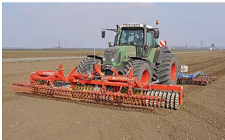
Avant SX 610-56 U mit Einebnungs- striegel zur Saatbettbereitung
